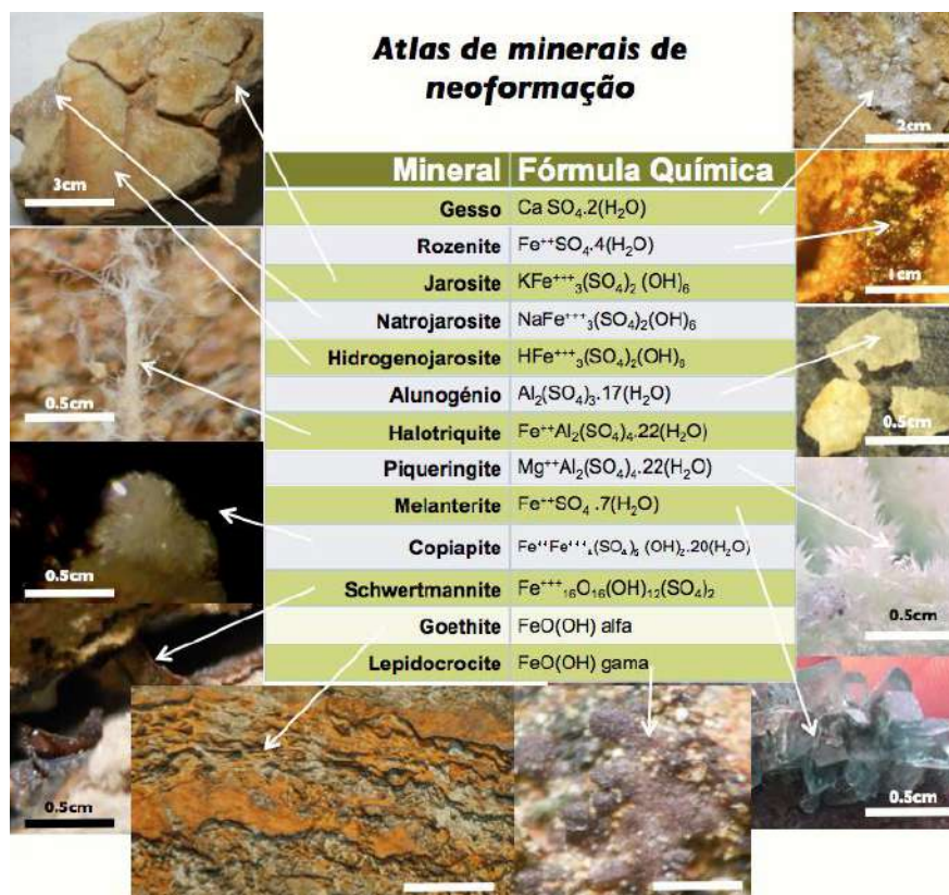
Figura 10 Atlas de minerais de neoformação supergênica (sais sulfatos e oxi-hidróxidos) identificados por DRX na escombreira da mina da Cerdeirinha, indicadores de diferentes estados de equilíbrio das zonas diferenciadas na escombreira.
