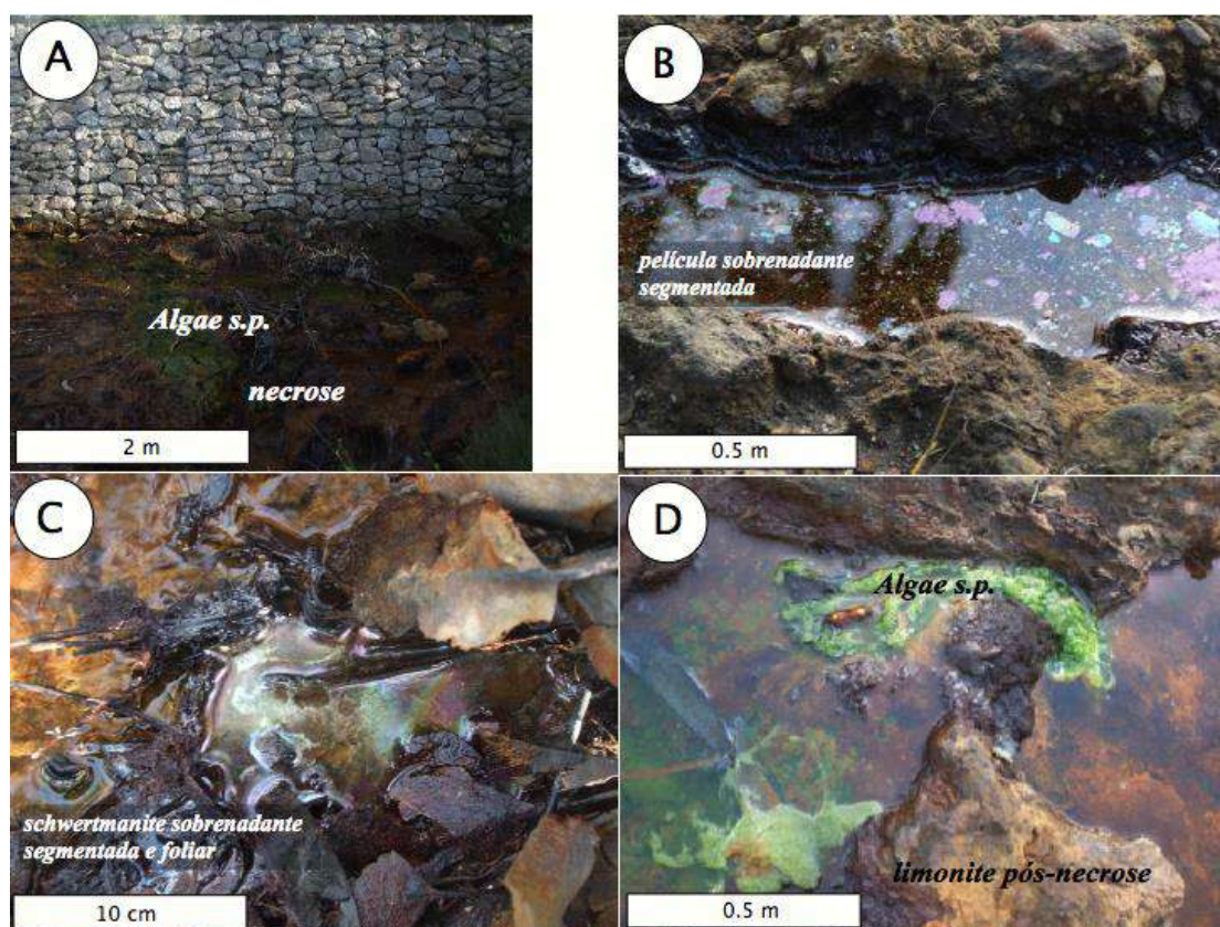
Figura 5 – Evolução do efluente ácido sulfatado nas escombreiras principais da mina de Valdearcas. A – colonização de algas em diferentes estados de evolução geoquímica; B – películas de schwertmanite de baixa cristalinidade sobrenadantes em relação ao efluente; C – placas e filmes fracturados e evoluídos de schwertmanite coexistentes com detritos vegetais em decomposição numa obliteração da escorrência sujeita a crustificação; D – aspectos extremos, desde a colonização inicial pelas algas filamentosas até à litificação dos seus produtos necróticos por oxi-hidóxidos de Fe.
