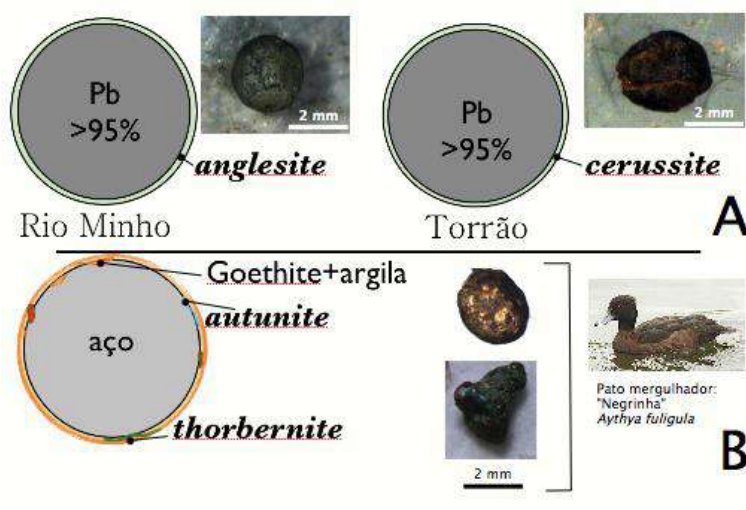
Figura 16 Secções em grãos de cartuchos de caça e síntese figurativa das observações efectuadas em microscópio electrónico de varrimento em modo, electrões retrodifundidos, seguidas de análise química semiquantitativa em modo, dispersão de energias. A - grãos obtidos em concentrados de bateia em linhas de água permanentes da Bacia do Rio Minho e linha de água sazonal que drena para o rio Sado (região do Torrão, Alcácer do Sal); B - grãos obtidos no conjunto dos gastrólitos extraídos da moela de um indivíduo de Aythya fuligula capturado no estuário do Rio Minho em 2009.
