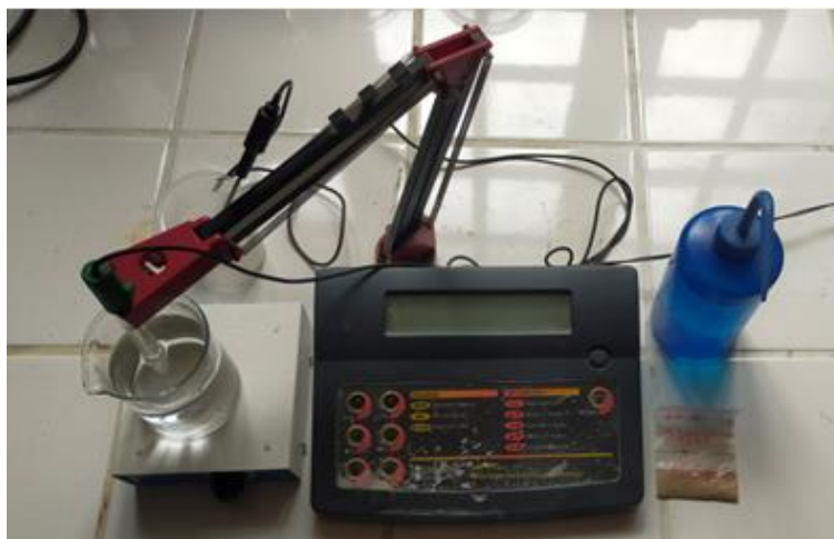
Fig. 11 : le matériel utilisé pour la pH-métrie.
