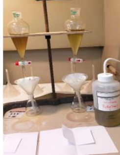
Fig. 7 : système de la séparation des minéraux
