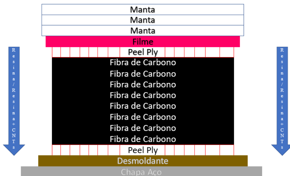
Figura 30 – Sequência de montagem dos elementos de produção do compósito
