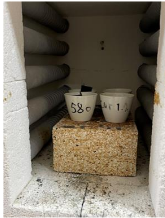
Figura 54 – Colocação cadinhos no forno
