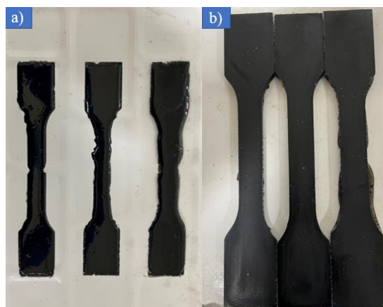
Figura 37 – Provetes Resina 580-CF-CNT-1– a) Moldados e b) Desmoldados
