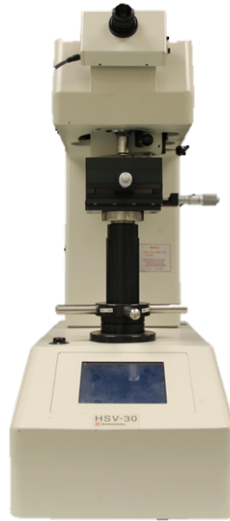
Figura 13. Vickers Hardness Tester — HSV-30 (Shimadzu Corporation, Kyoto, Japão).
