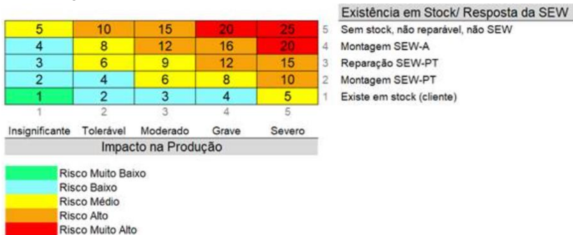
Figura 21 - Matriz de Risco utilizada para avaliar a criticidade de cada equipamento.
