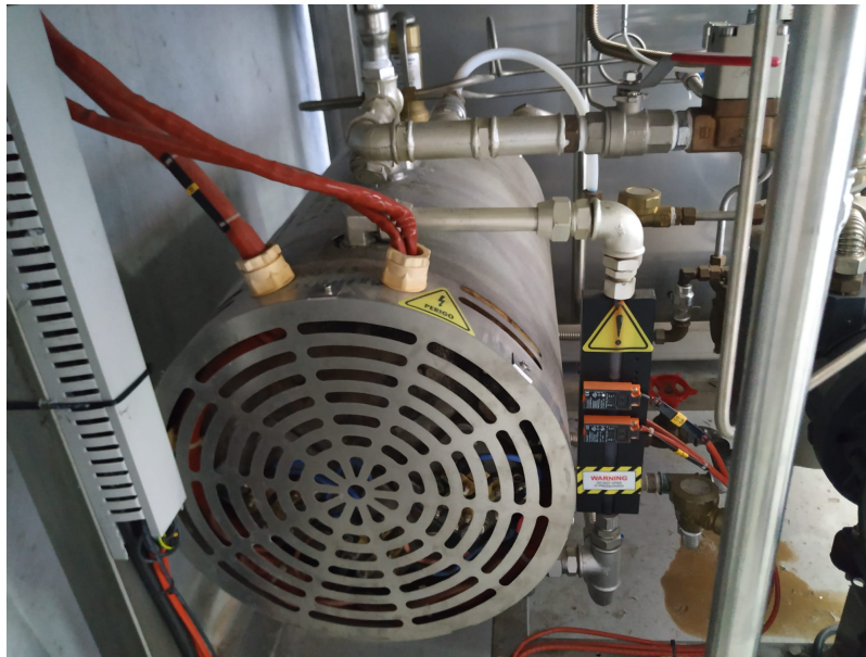
Figura 3.5: Gerador de vapor de um AJC Amaro 5000
