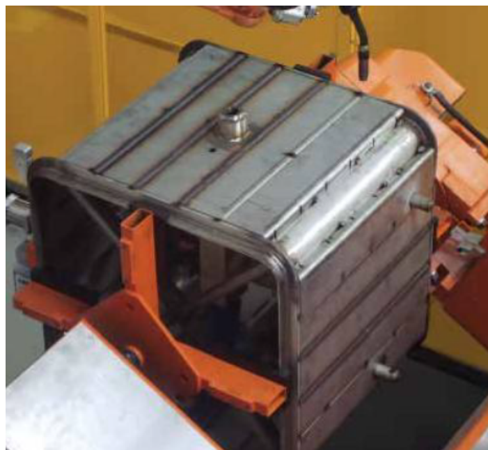
Figura 3.4: Câmara e camisa durante o processo de fabrico ( https://t.ly/fwC96 )
