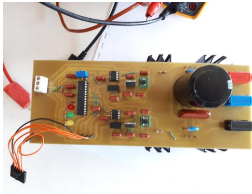
Figura 3.19 – Montagem experimental do conversor CC/CC de 2 quadrantes
