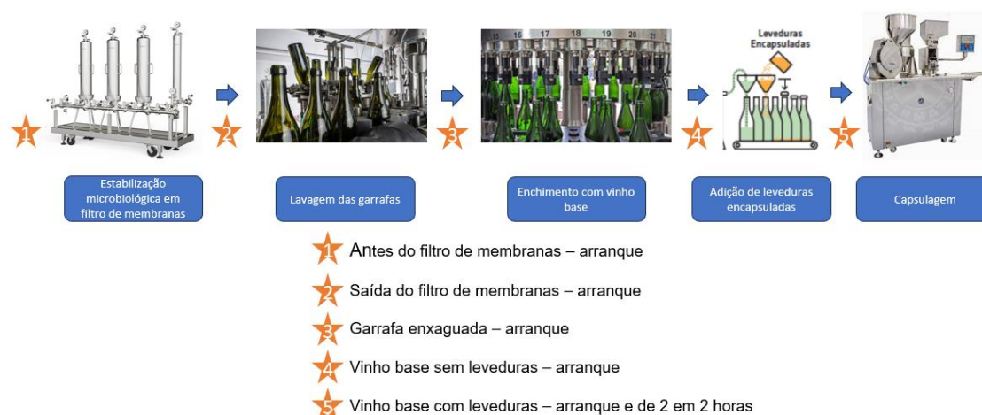
Figura 34 – Plano de controlo e análise microbiológica para a etapa de tiragem no processo de produção de espumantes na empresa Global Wines S.A., com referência aos pontos de recolha das amostras.
