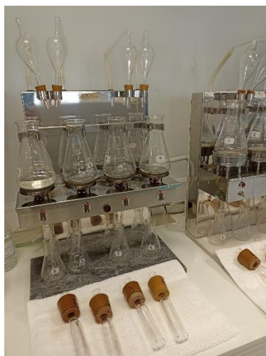
Figura 30 – Aparelho de destilação Cazenave-Ferré, para determinação da acidez volátil em vinhos, em uso no laboratório da Global Wines S.A.
