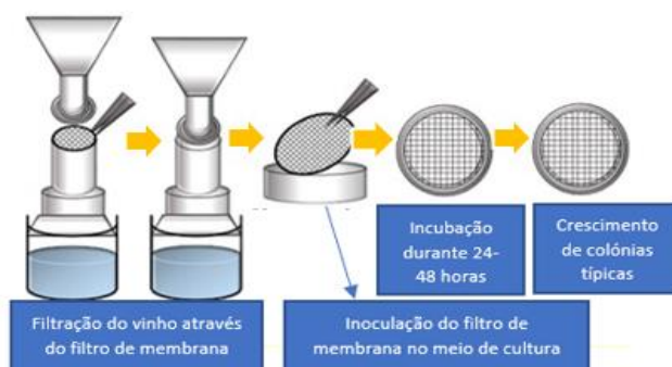
Figura 27 – Método de filtração por membrana, usado na deteção e quantificação de microrganismos presentes em vinhos engarrafados (adaptado de Fugelsang & Edwards, 2010).
