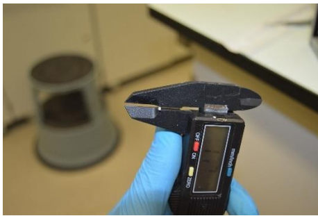
Figura 26 - Medição dos palitos com craveira digital
