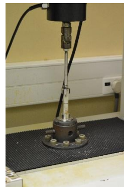
Figura 29 - Máquina de testes universal a tracionar o palito
