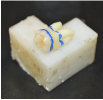
Figura 14 - Dente colocado no fixador com marcações a seccionar
