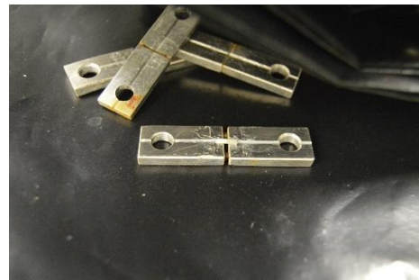
Figura 27 - Jig de aço inoxidável com palito colado
