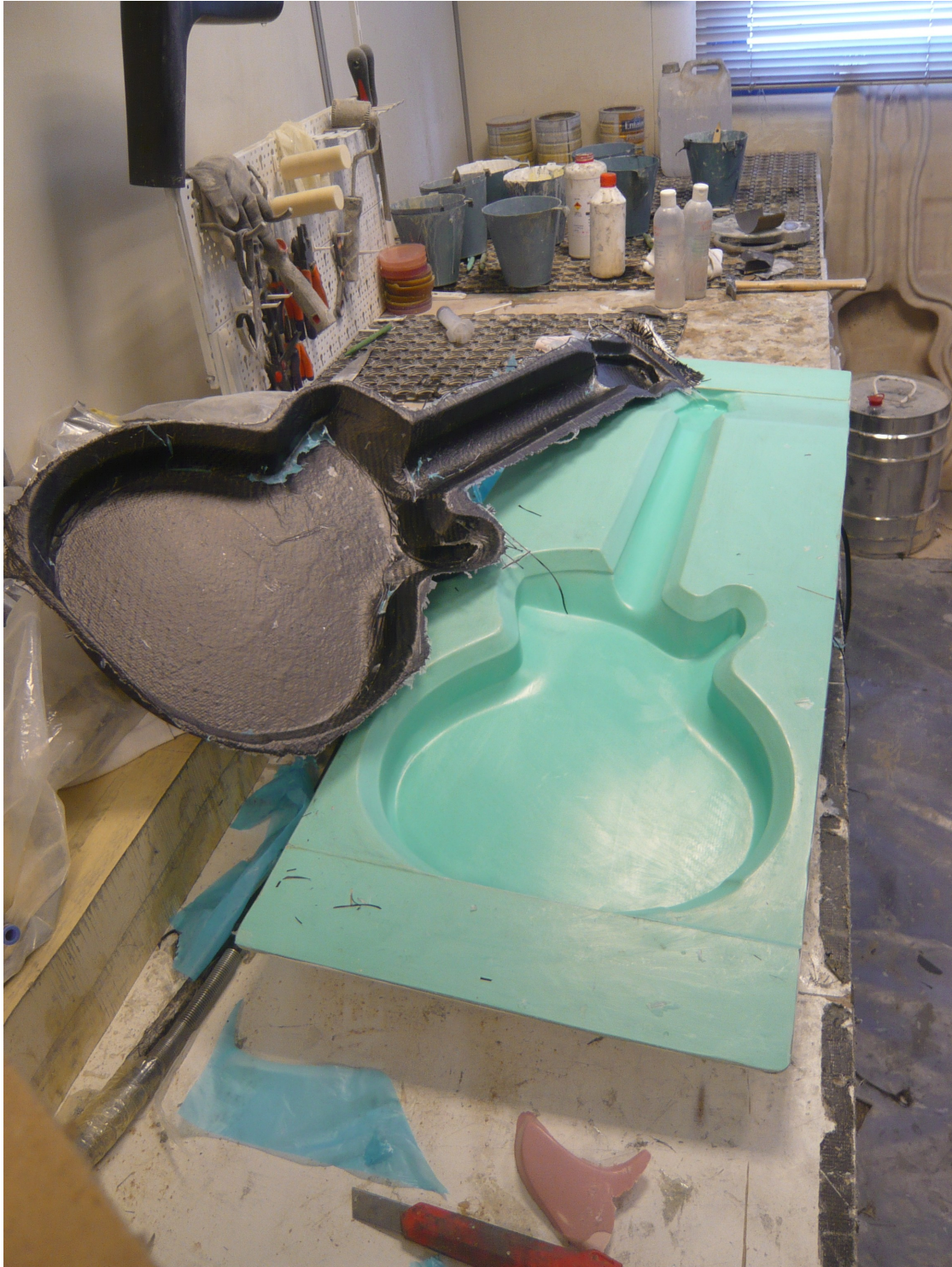
Figura 50 - Peça das costas pós-desmoldagem
