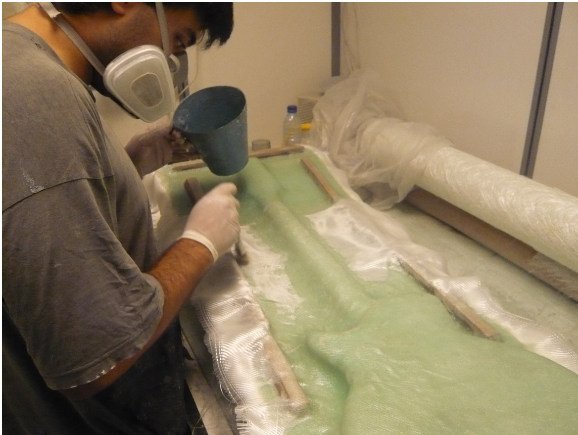
Figura 45 - Laminação com fibra de vidro.
