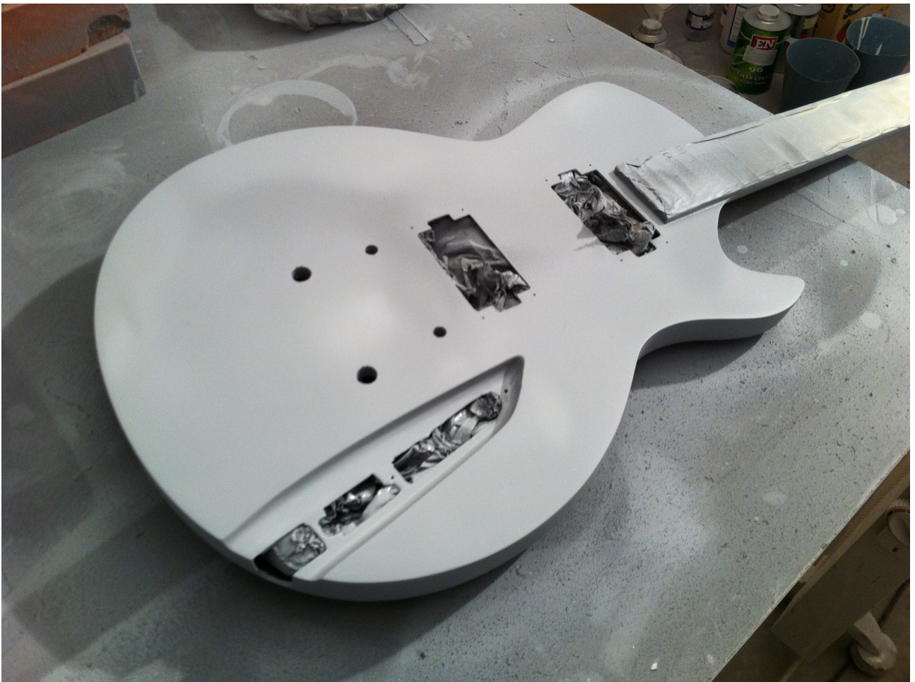
Figura 55 – Aplicação de primário no corpo da guitarra
