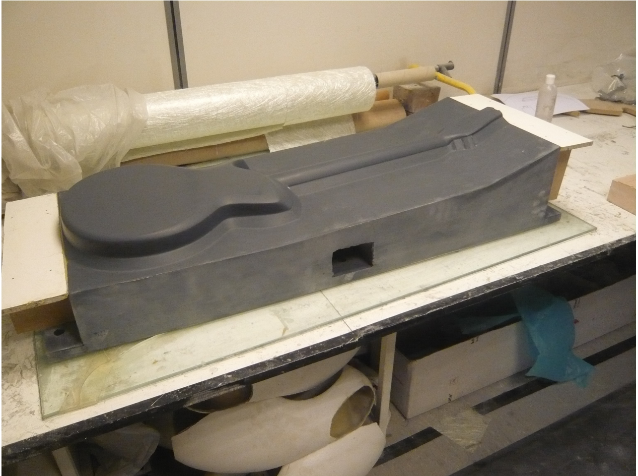
Figura 43 – Modelo maquinado em poliuretano de baixa densidade com topcoat de epóxico (parte inferior)
