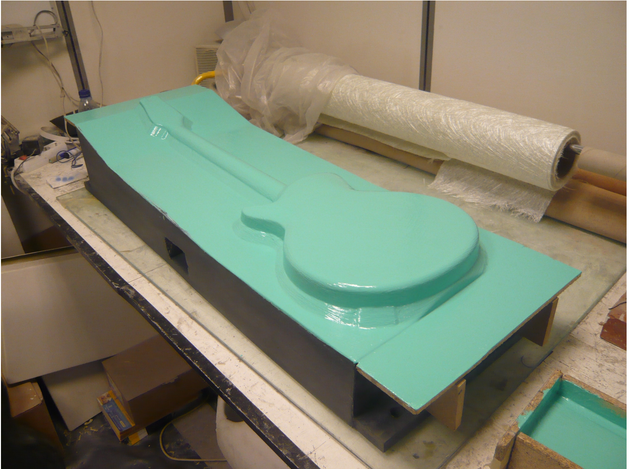
Figura 44 - Aplicação de gel coat de epóxico no modelo
