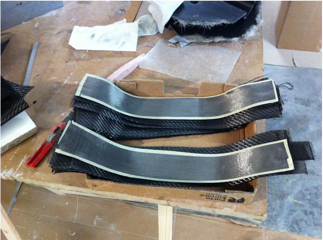
Figura 51 – Camadas de fibra pré-cortadas para a construção de escalas
