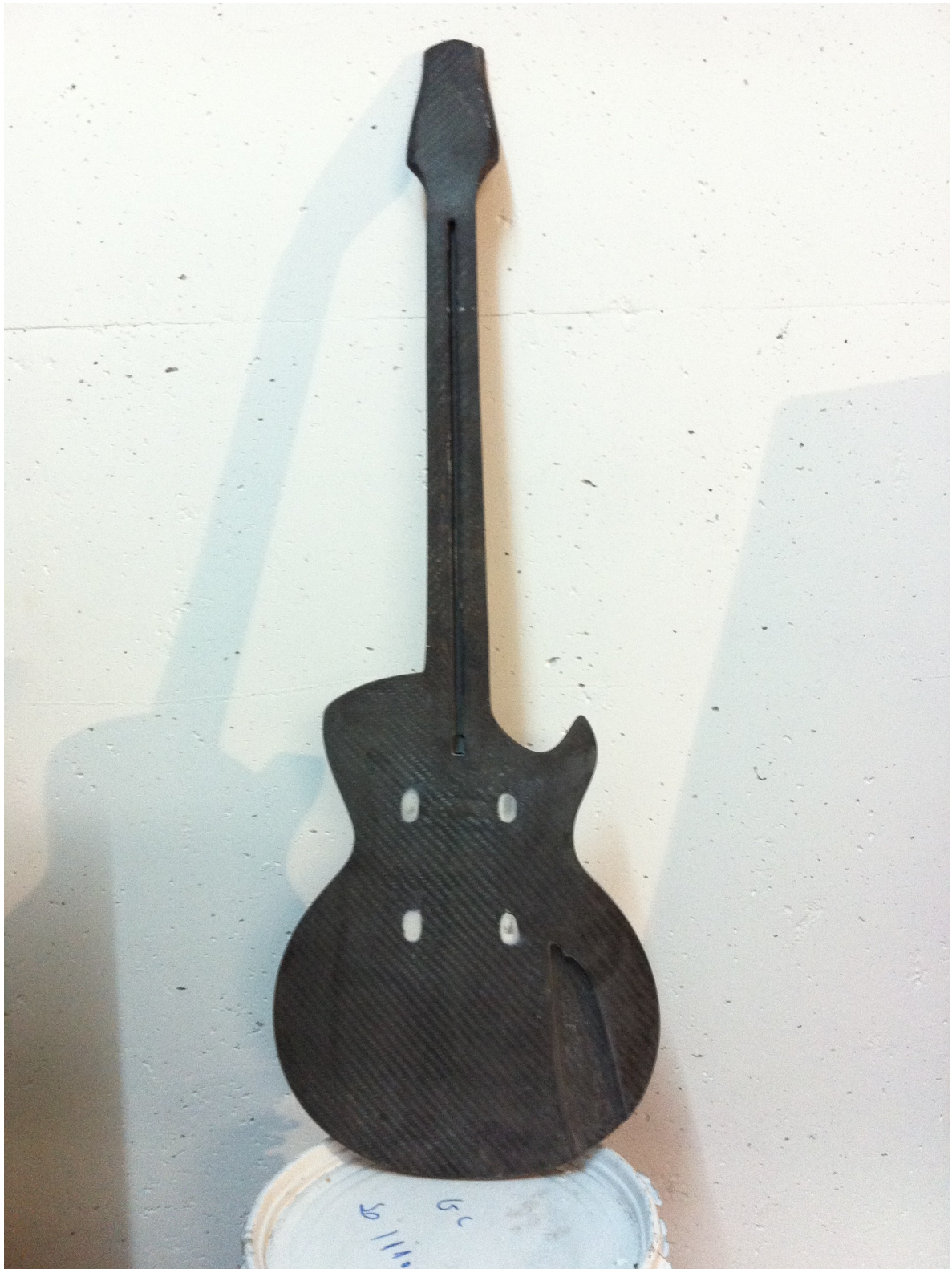
Figura 52 - Corpo da guitarra completo antes dos cortes para hardware e electrónica
