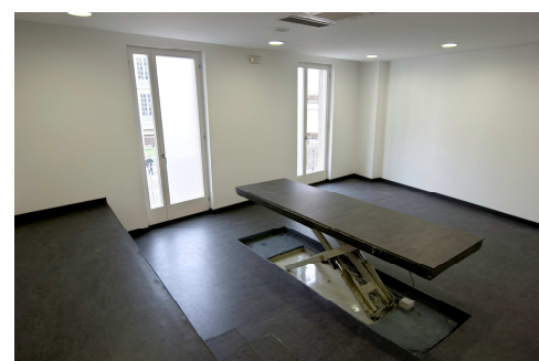
Fig. 6.7.17 Mesas con mecanismo hidráulico.
