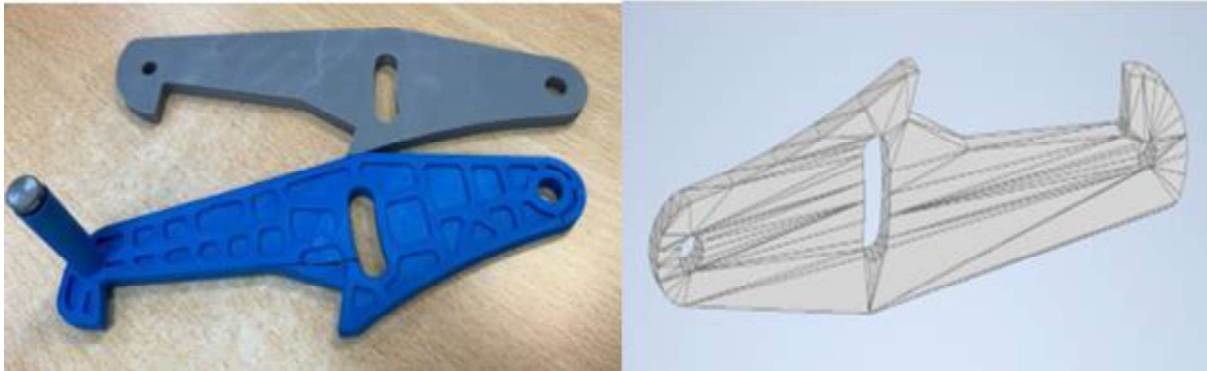
Figura 5-12 — Balanceador Aéreo das Portas Av e o seu Desenho CAD
