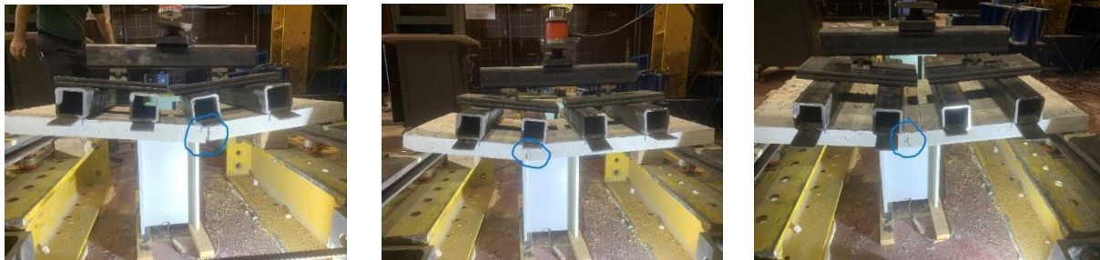
Figura 59 - Rotura das pré-lajes de BF0 (esquerda), BF6 (centro) e BF10 (direita) no Setup 2 .
