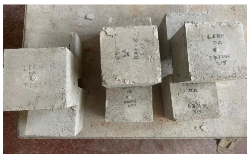
Figura 24 - Provetes cúbicos de betão simples (esquerda), com 6 kg/m 3 (centro) e 10kg/m 3 de fibras (direita) após ensaios de compressão.
