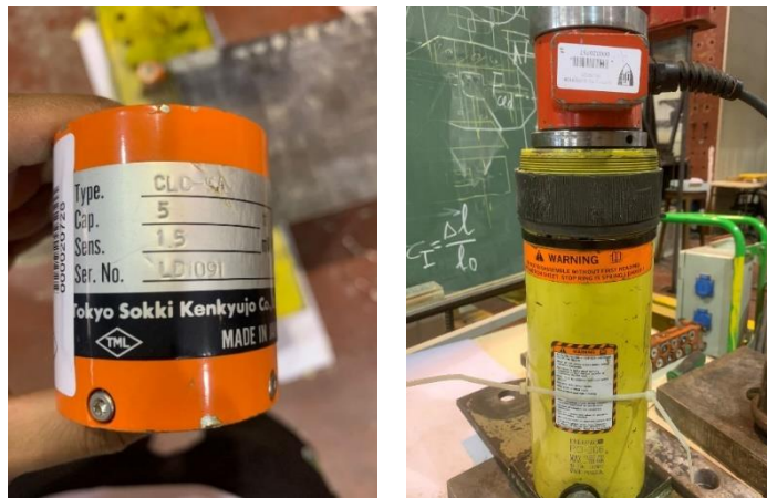
Figura 38 - Célula de carga e macaco hidráulico, respectivamente, usados nos ensaios.
