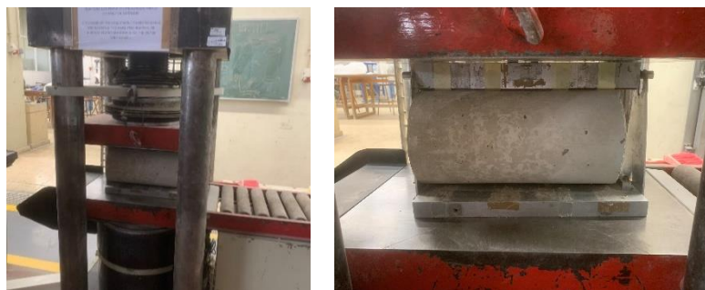
Figura 26 - Máquina de ensaio à compressão diametral e exemplo de um provete durante um ensaio.
