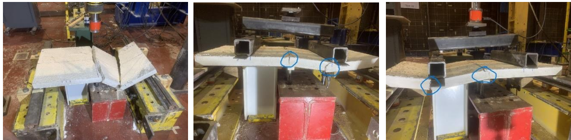
Figura 61 - Rotura das pré-lajes de BF0 (esquerda), BF6 (centro) e BF10 (direita) no Setup 3.
