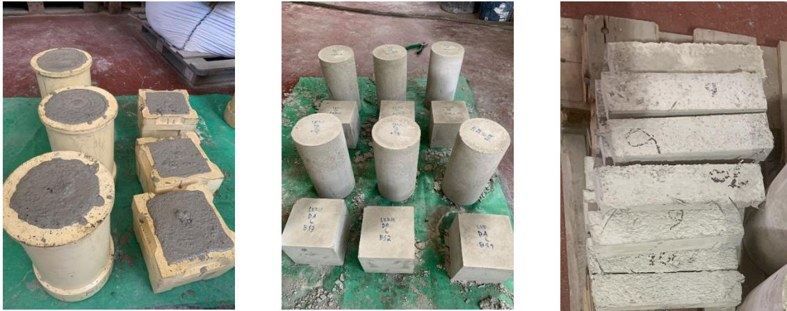
Figura 21 - Betonagem e descofragem dos provetes cúbicos e cilíndricos e provetes prismáticos.
