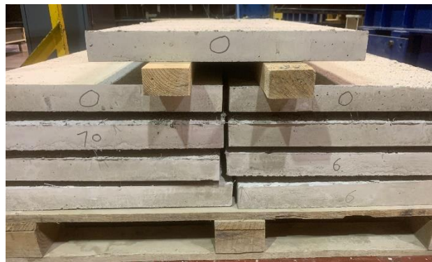
Figura 20 - Aspeto final das pré-lajes após descofragem.
