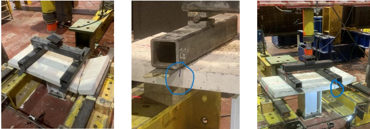
Figura 57 - Rotura das pré-lajes de BF0 (esquerda), BF6 (centro) e BF10 (direita) no Setup 1.
