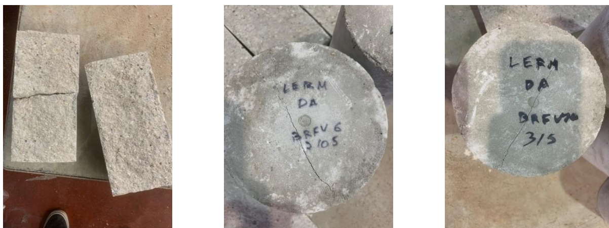
Figura 27 - Provetes cilíndricos de betão simples (esquerda), com 6 kg/m 3 (centro) e 10kg/m 3 de fibras (direita) após ensaios de compressão diametral.
