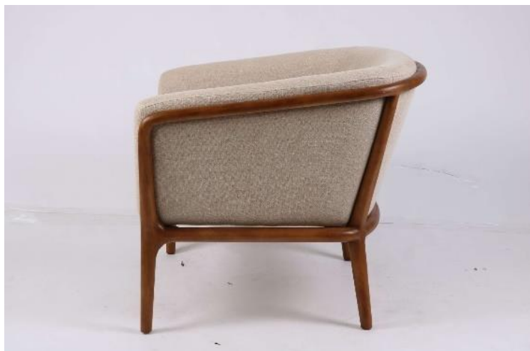
Figura 36 Alinhamento desnivelado entre almofada e estrutura
