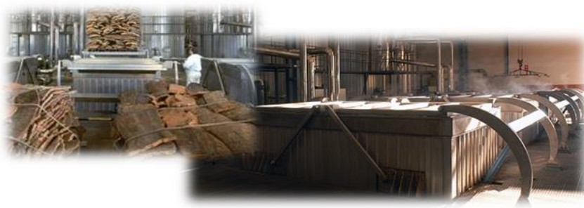
Figura 2.2 Cozedura da cortiça (adaptado de Amorim, 2012; Silva, 2012).
