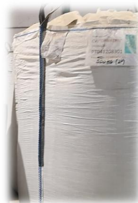
Figura 95- Bigbag devidamente identificado
