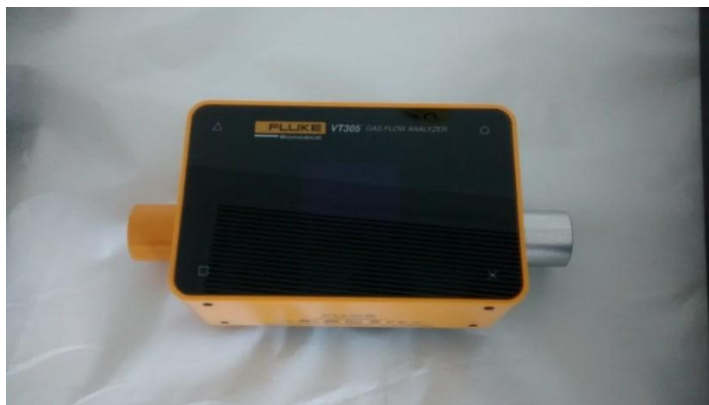
Figura 13 – Equipamento de teste de ventiladores ( Fonte própria )
