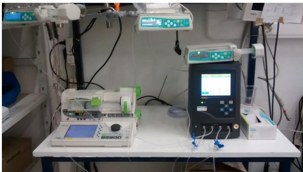
Figura 35 – Montagem do teste de fluxo e de pressão a bombas infusoras e perfusoras ( Fonte própria )
