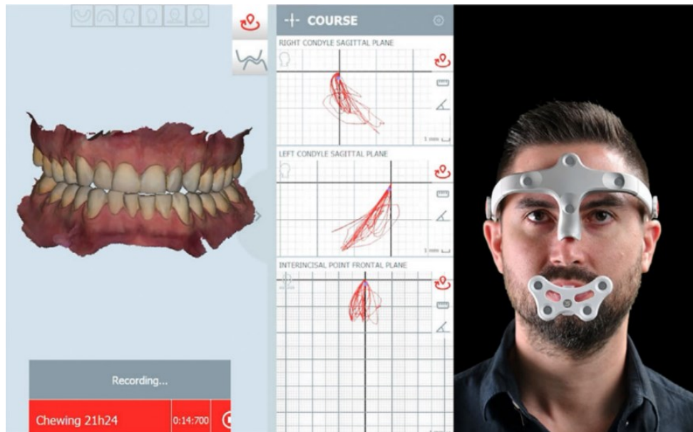
Figura 17- Modjaw® a registar a cinemática mandibular no plano frontal e plano sagital (Marta Revilla-Leon et al., 2023).
