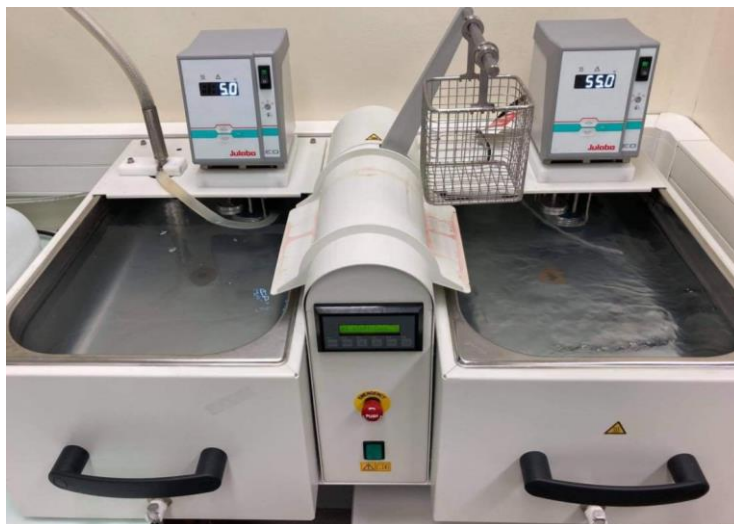
Figura 21: Máquina termocicladora Julabo Labortech® com o tanque esquerdo a 5°C e o direito a 55°C, pronta para começar os ciclos de termociclagem.
