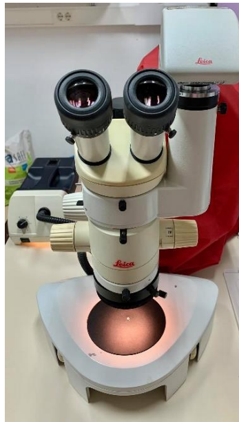
Figura 28: Estereomicroscópio Leica MZ6 com um bracket a ser analisado.
