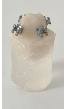
Figura 23: Amostra preparada com o cilindro de acrílico.
