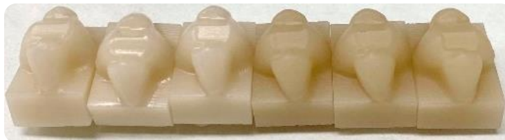
Figura 4: Seis blocos de cerâmica de dissilicato de lítio com quatro faces cada um.
