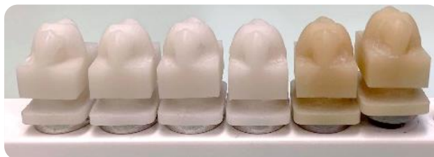
Figura 3: Seis blocos de cerâmica feldspática com quatro faces cada um.
