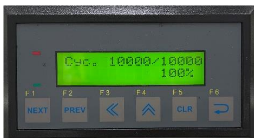
Figura 22: Ecrã da máquina termocicladora Julabo Labortech® uma vez completados os 10000 ciclos.
