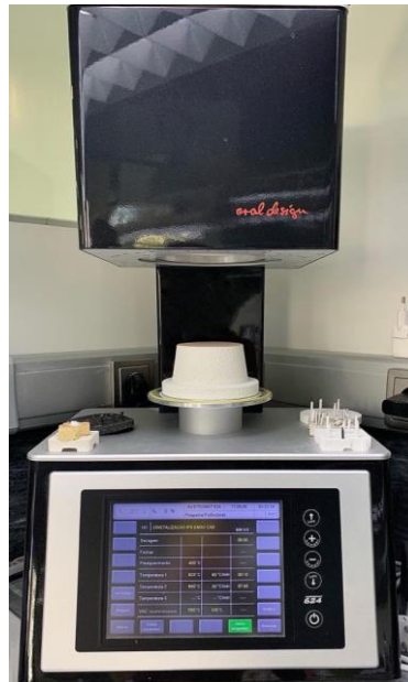
Figura 14: Forno de cerâmica utilizado nas amostras de dissilicato de lítio.
