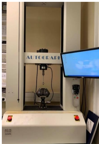
Figura 25: Máquina de Testes Universal Shimadzu Autograph do Laboratório de Biomateriais do IUEM.
