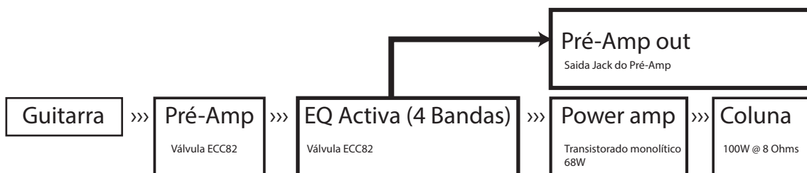
Fig. 12 Estrutura de funcionamento da electrónica
