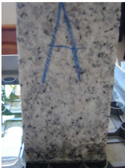
Figura 69. Altura de água de 3mm acima da base dos provetes.
