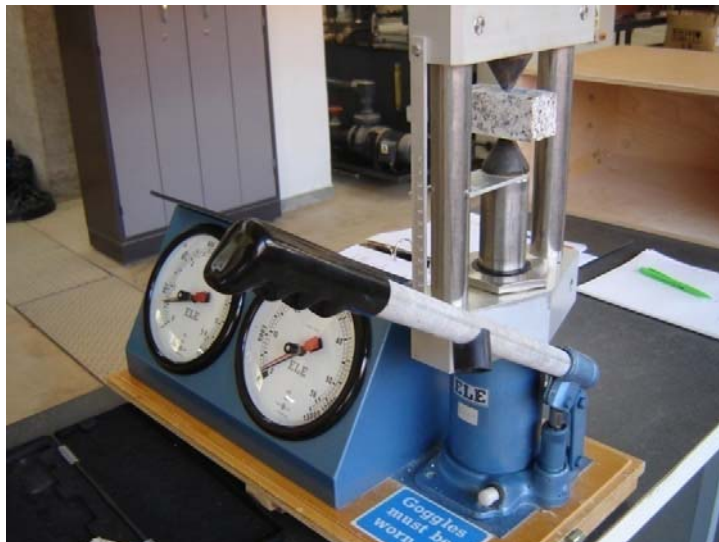
Figura 88. Duas ponteiras cónicas de vértices arredondados com ângulos de 60^\circ .
