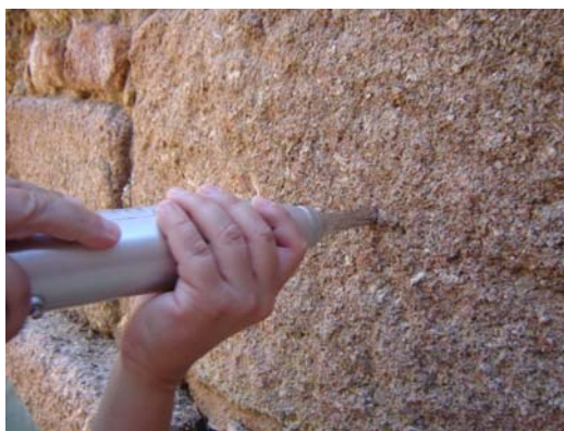
Figura 91. Ensaio com esclerómetro.
