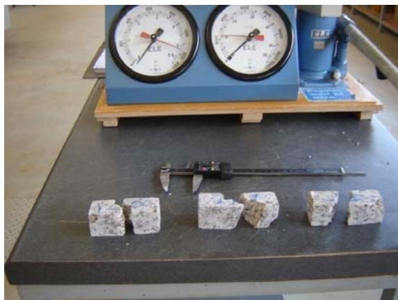
Figura 89. Três dos seis provetes após a rutura.
