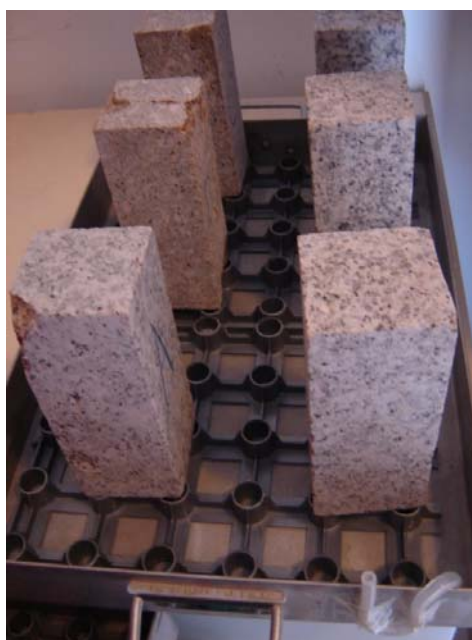
Figura 67. Colocação dos provetes.
