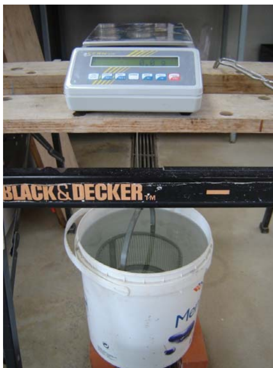
Figura 65. Processo para obtenção do peso da amostra saturada imersa em água, W_{\text{submerso}} .
