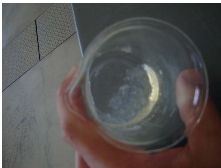
Figura 72. Material gelatinoso para um melhor contacto entre os transdutores e os provetes.
