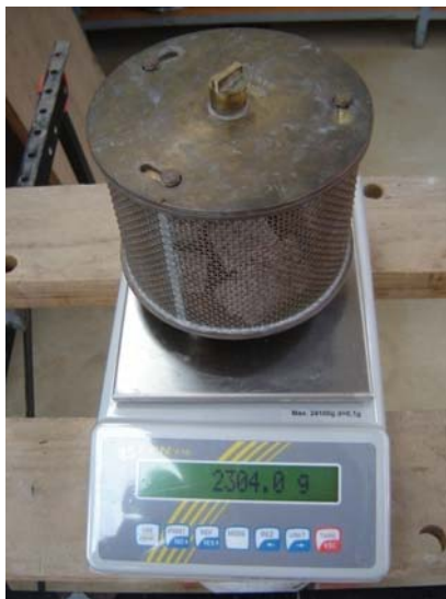
Figura 79. Pesagem do tambor após secagem em estufa.
