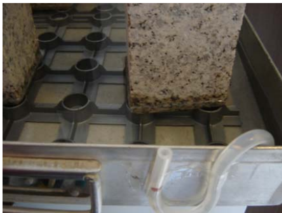
Figura 68. Dispositivo que permitiu ter um nível de água constante.
