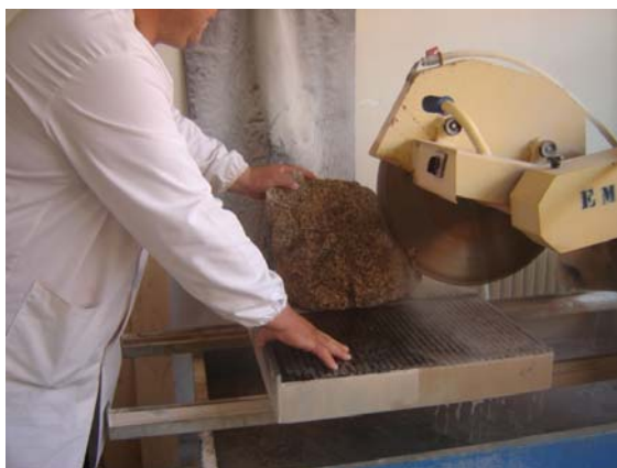
Figura 58. Corte da pedra para preparação dos provetes.
