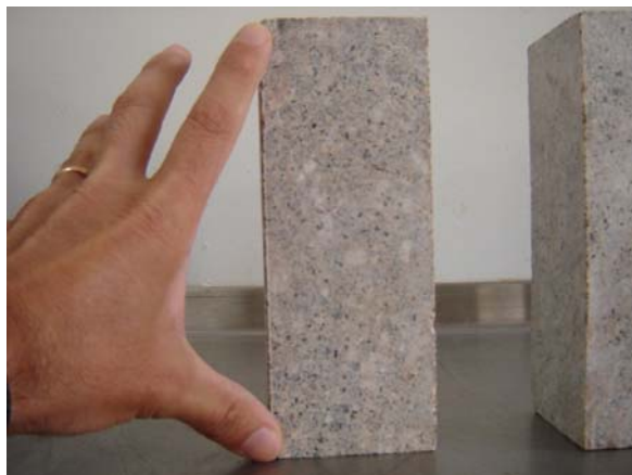
Figura 59. Provetes com dimensões normalizadas.
