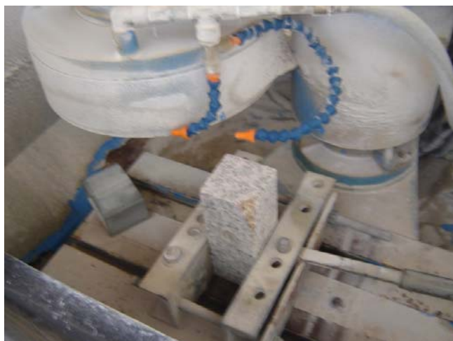
Figura 83. Regularização das faces dos provetes.
