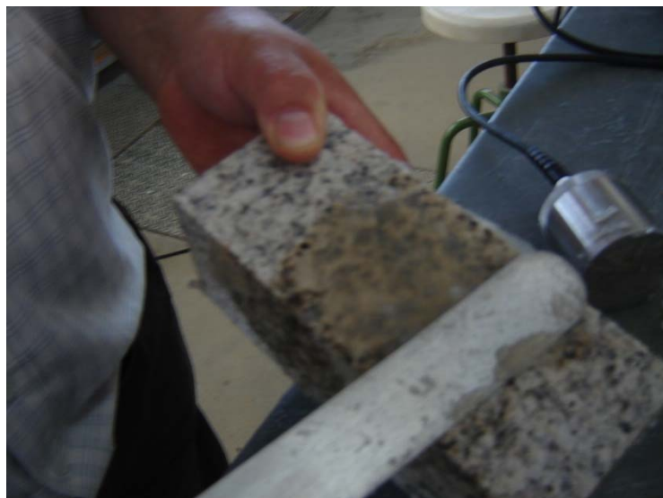
Figura 75. Colocação do material gelatinoso entre o transdutor e a superfície do provete.
