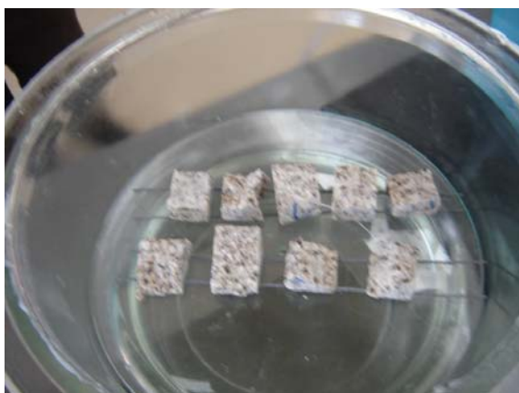
Figura 80. Conjunto de dez fragmentos destinados ao provete húmido.
