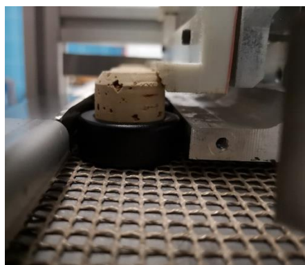
Figura 49 - Pormenor das rolhas no descapsulador
