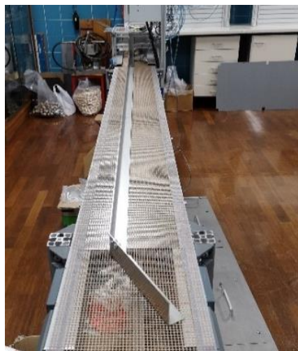
Figura 34 - Configuração aperfeiçoada da guia de encaminhamento de rolhas
