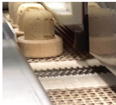
Figura 56 - União metálica da tela transportadora
