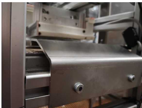
Figura 35 - Configuração inicial do batente fixo de prisão de cápsulas
