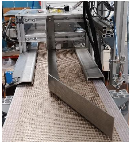
Figura 33 - Configuração inicial da guia de encaminhamento de rolhas
