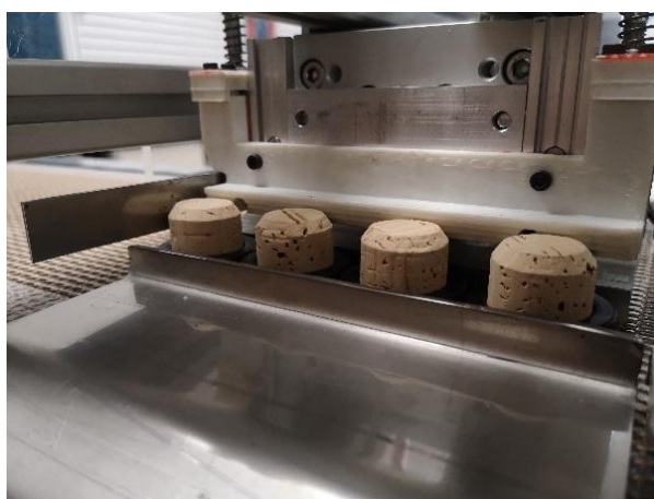
Figura 36 - Configuração aperfeiçoada do batente fixo de prisão de cápsulas
