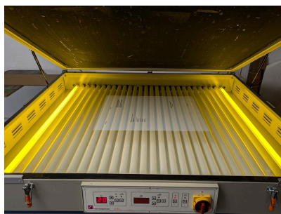
Figura 32: Posicionamento do fotolito na máquina de gravação UV. Elaboração própria.
