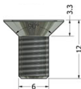
Figura 23 - Dimensões da cabeça de um parafuso (Central Industrial Solutions, 2016)
