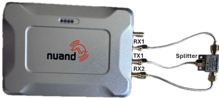
Figura 4.30: Esquema de montagem em MISO.
