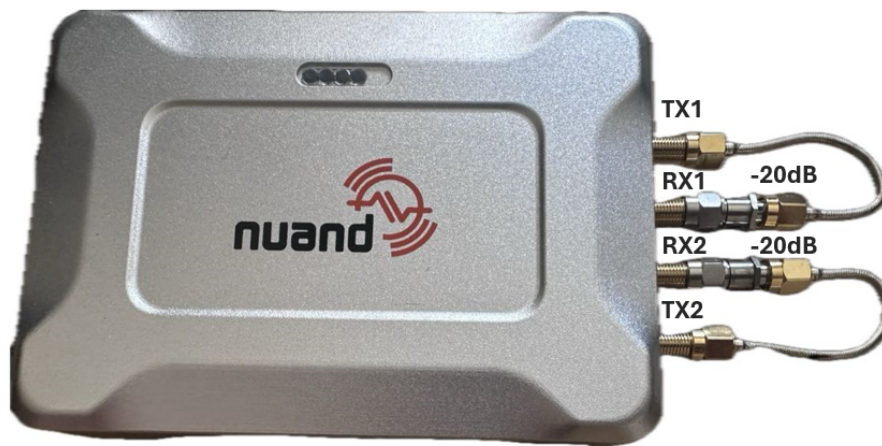
Figura 4.32: Esquema de montagem em MIMO.
