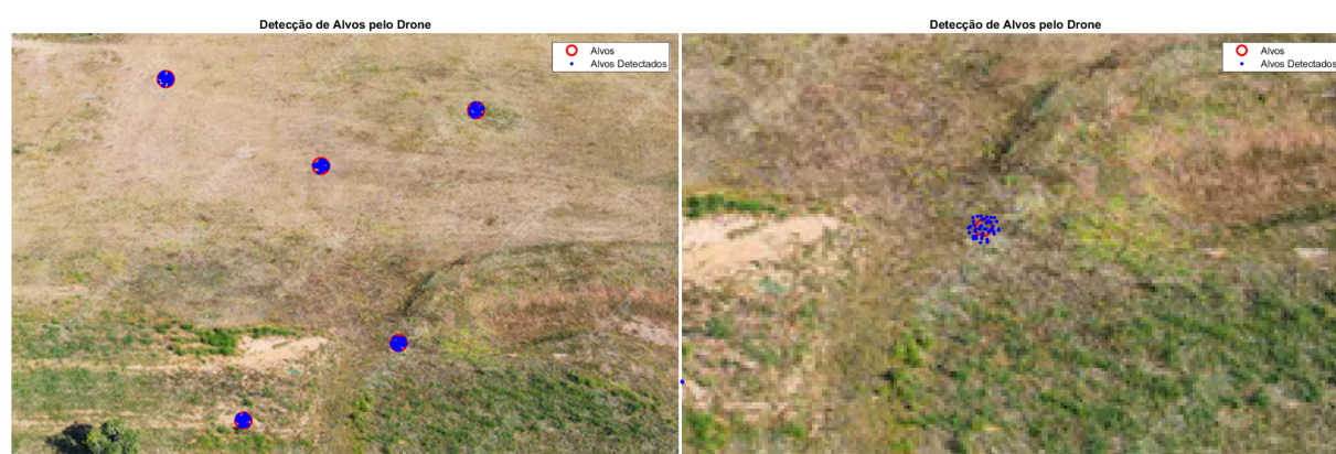
Figura 3.13: Informação gráfica obtida através do tratamento dos dados contidos no ficheiro CSV: à direita uma aproximação de uma secção da imagem da esquerda, mostrando detalhes dos alvos detetados.
