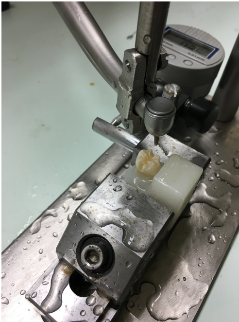
Figura 6: Preparação da cavidade
