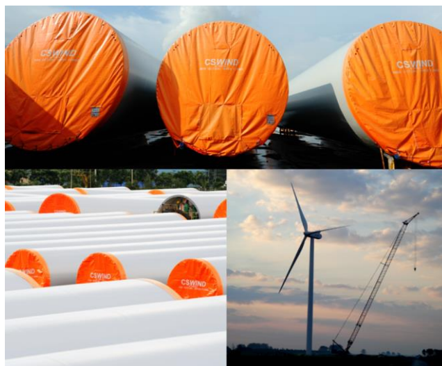
Figura 3 - Secção de Torre Eólica
