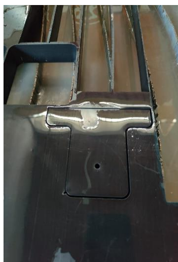
Figura 47 – Produção do freio por corte a jato de água
