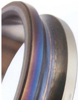
Figura 12 – Anel interior termicamente afetado Fonte: Barden
