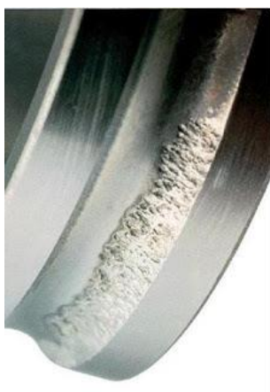
Figura 11 – Exemplo de carga excessiva no anel interior Fonte: Barden
