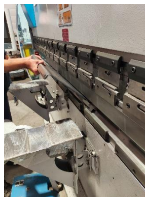
Figura 54 – Processo de quinagem da base
