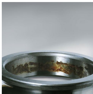
Figura 18 – Exemplo de corrosão no anel exterior Fonte: Barden
