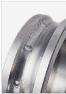
Figura 13 – Brinelling falso Fonte: Barden
