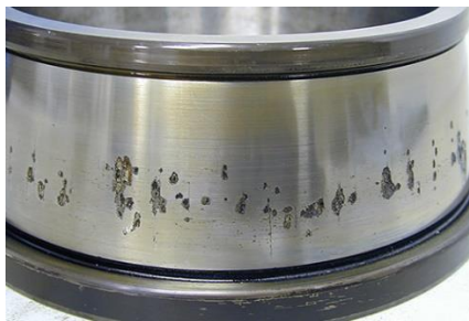
Figura 16 – Resultado da contaminação no anel interior Fonte: Timken
