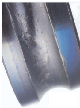
Figura 17 – Exemplo de falha por lubrificação Fonte: Barden
