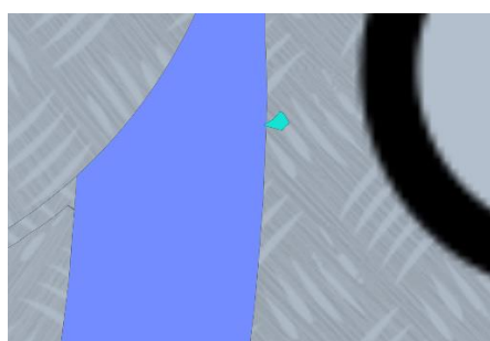
a) 1º nível de falha na pista exterior
