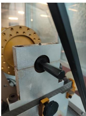
Figura 36 – Chumaceira-rolamento danificado montado no veio da spectraquest
