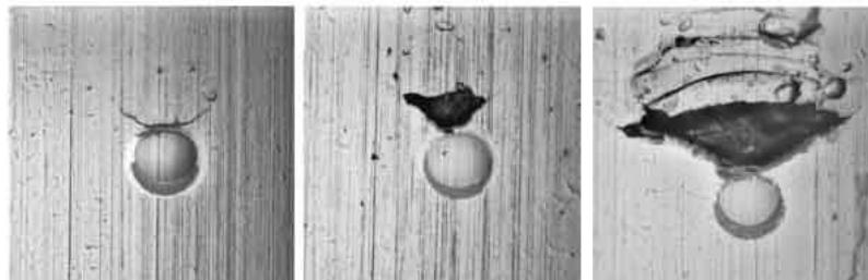
Figura 10 – Evolução do fenómeno de spalling ou flaking
