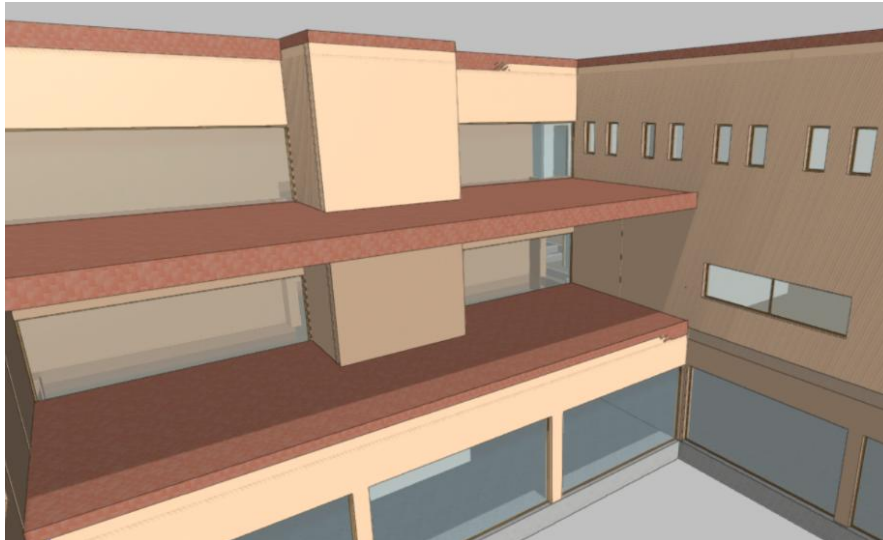
Figura 2.9 - Efeito do sombreamento da laje plana não acessível (CYPE, 2024).
