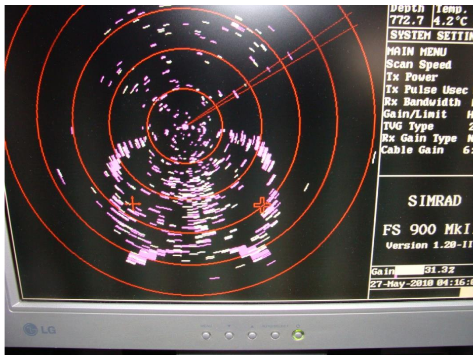
Fig.47 - Imagem de sonar, boca da rede e capturas
