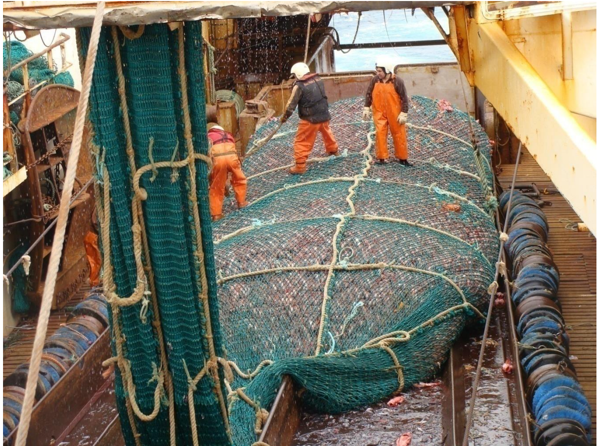
Fig.40 - Cabos de reforço transversais (forcas ou anéis)
