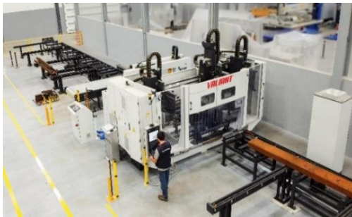
Figura 5. Corte e Maquinação de Vigas/ Perfis
