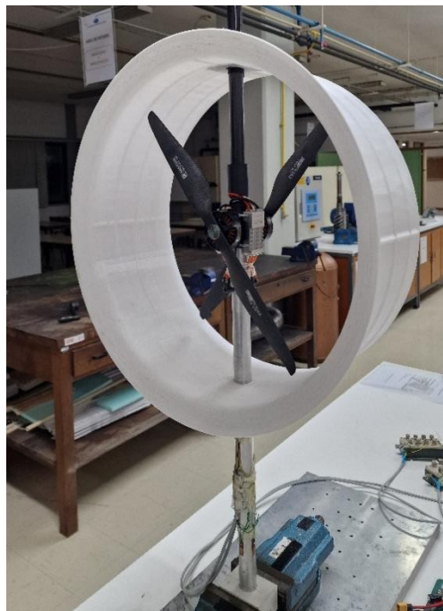
Figura 3.7 - Conduta com hélices de 16" instalada no banco de ensaios.
