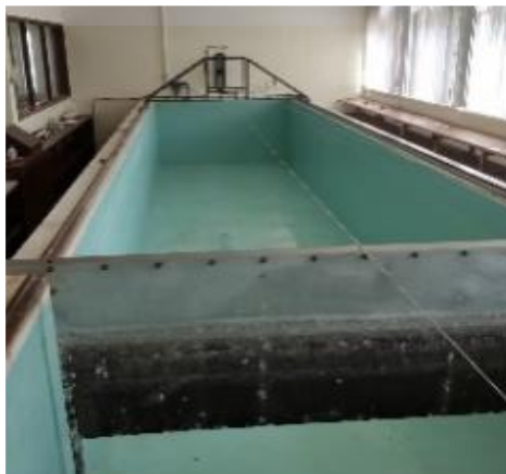
Figura 20 - Gerador de ondas
