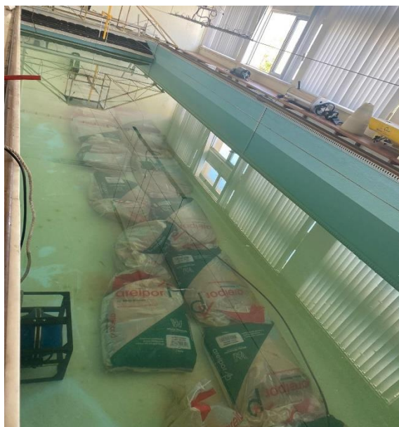
Figura 22 - Disposição dos Testes A com o altifalante subaquático na posição 1
