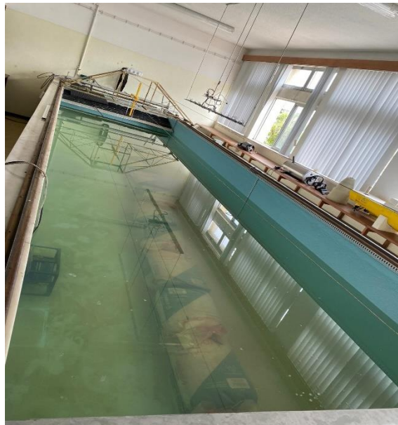
Figura 24 - Disposição dos Testes B com o altifalante subaquático na posição 1
