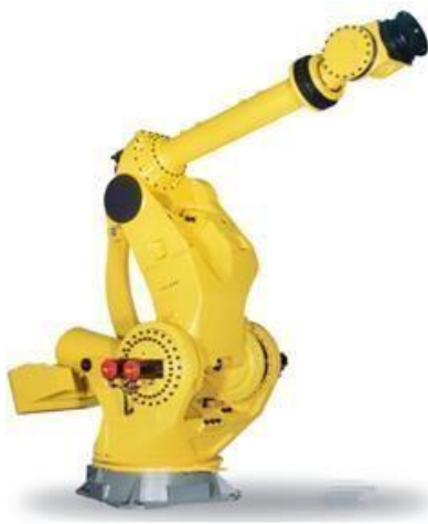
Figura 2.29 - Robô industrial com capacidade de carga de 1.200 kg e alcance horizontal de 4,6 m 4 .
