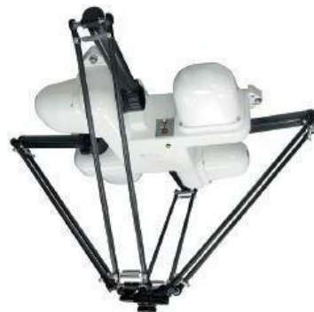
Figura 2.26 - Robô de coordenadas paralelas.
