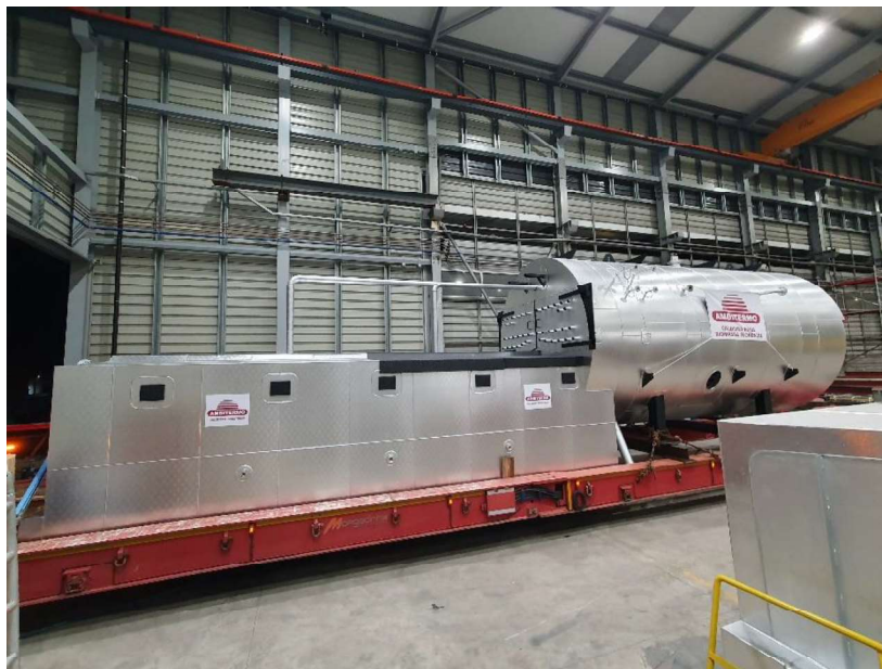
Figura 2- Caldeira a biomassa Ambitermo a abandonar a fábrica.
