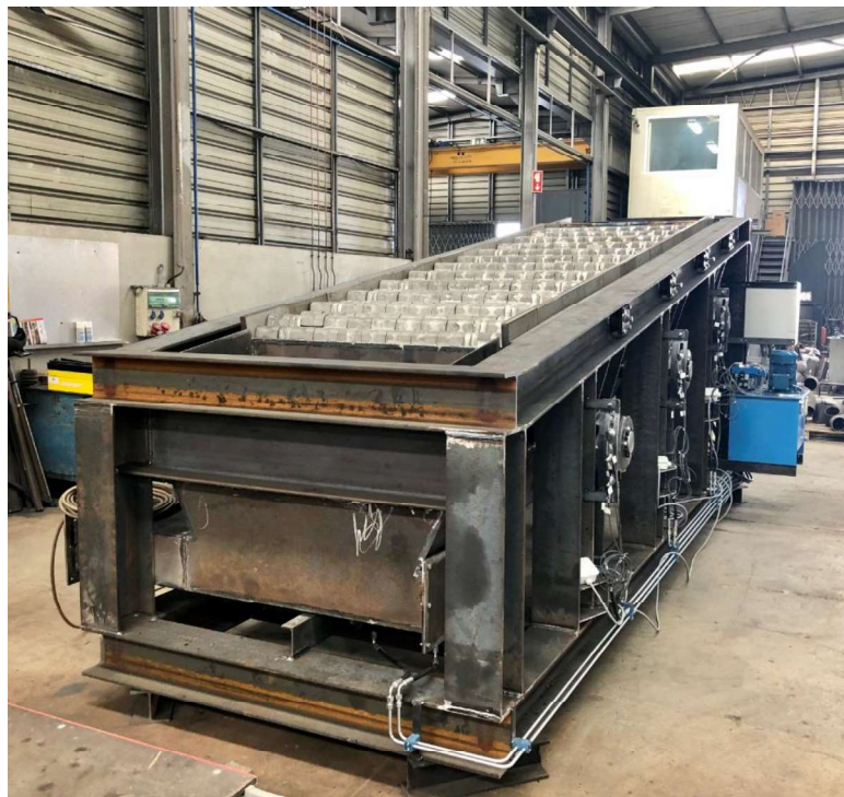
Figura 49 - Grelha móvel em testes de fábrica.
