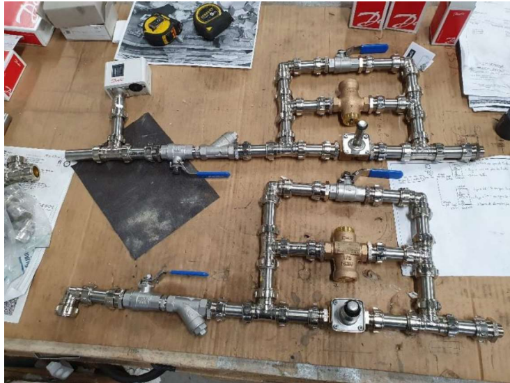
Figura 45 - Montagem em fábrica de uma parte do sistema de extinção de incêndios.
