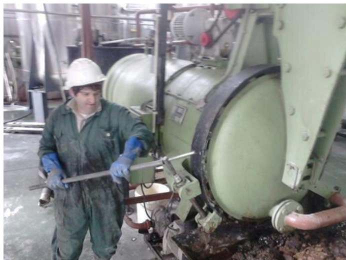
Abertura do filtro e parafuso de aperto e desaperto do filtro.
