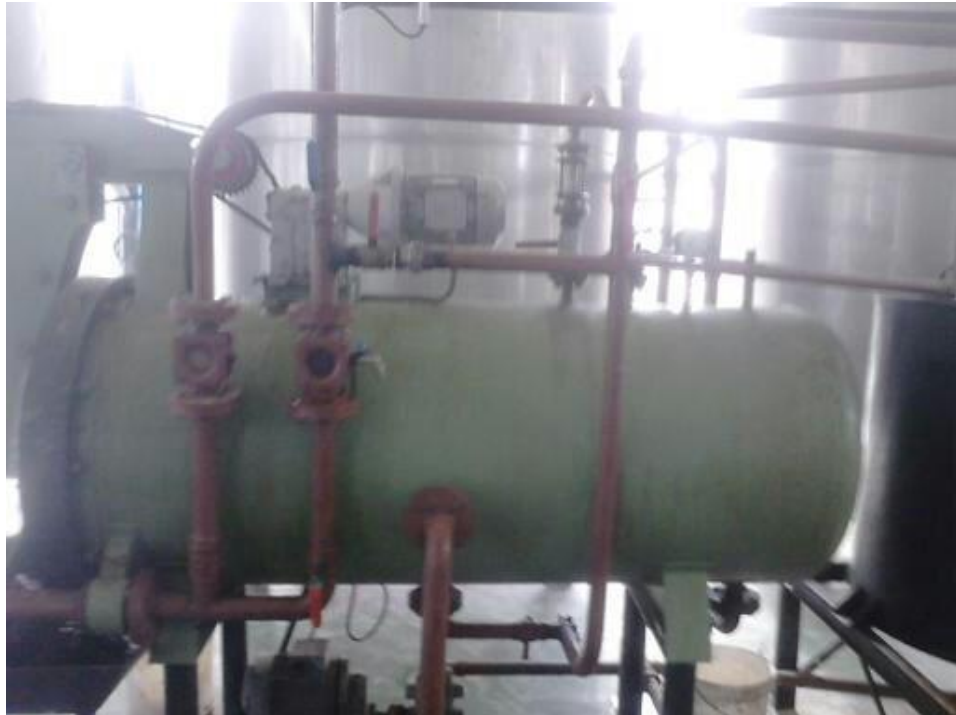
Figura 4: Filtro da refinaria onde o óleo e gordura são filtrados.
