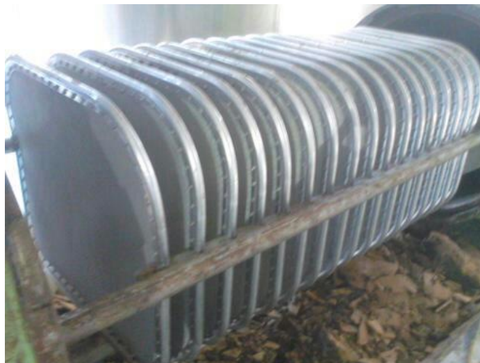
Placas de filtração após serem limpas
