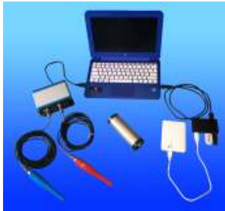
Fig 2: Componentes principais do sistema de gravação SAM Scribe (Mk1). A unidade SAM Scribe FS é vista do lado esquerdo, com os microfones por baixo e um computador notebook no topo centro. O calibrador é mostrado ao centro. O hub USB do lado direito tem um disco externo (esquerda), um GPS (centro) e um security hasp (direita).
