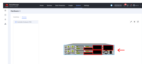
(b) Alarme gerado após falha de módulo de alimentação
