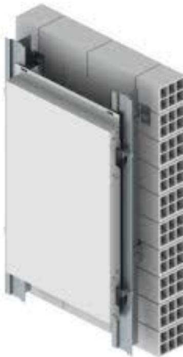
Figura 4.1 - Mecanismo de Revestimento de Fachada Ventilada
