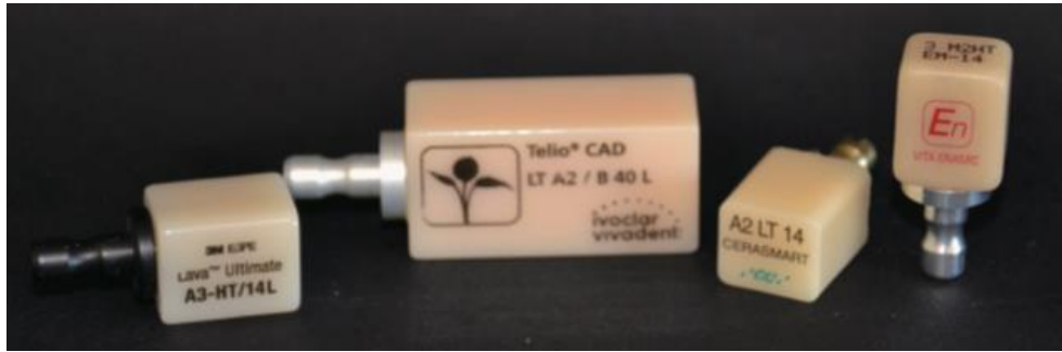
Figura 23. Diferentes tipos de blocos de resina maquinados com mandris diferentes (Adaptado com permissão de Lambert et al., 2017)
