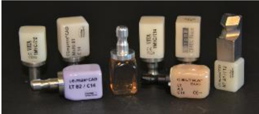
Figura 22. Diferentes tipos de blocos de cerâmicas maquinados com mandris diferentes (Adaptado com permissão de Lambert et al., 2017)
