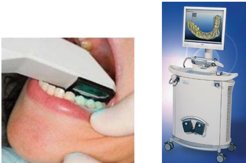
Figura 11. Sistema iTero® com o IOS e ecrã anexado (Adaptado com permissão de Logozzo et al., 2014)
