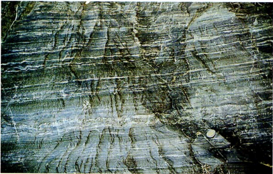
Foto 4 Aspecto do argilito com forte componente carbonatada e finas camadas de silte, correspondendo à fácies “Santo Xisto” da Fm. de Desejosa (Norte de Almendra).
