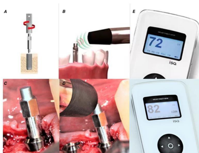
Figura 9 - Ilustração da análise da frequência de ressonância (RFA). (A), Inserção do adaptador de medição – (B), Frequências de ressonância medidas com o dispositivo – (C), Implante com adaptador in situ – (D), Medição RFA do lado vestibular – (E), Medidor de estabilidade do implante com valores do quociente de estabilidade do implante (ISQ) para a avaliação (Vollmer et al., 2020).
