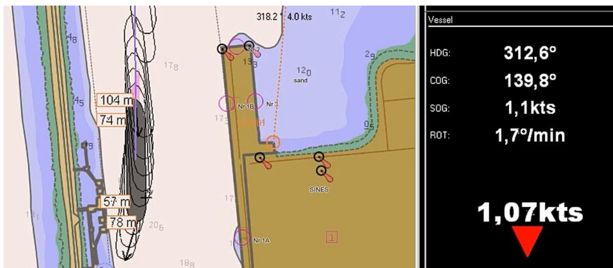
Figura 50 - Aproximação ao cais do navio Al Sahla com 315,6 metros de comprimento fora a fora, vento com direção entre sul e leste e intensidade de 15 a 20 nós
