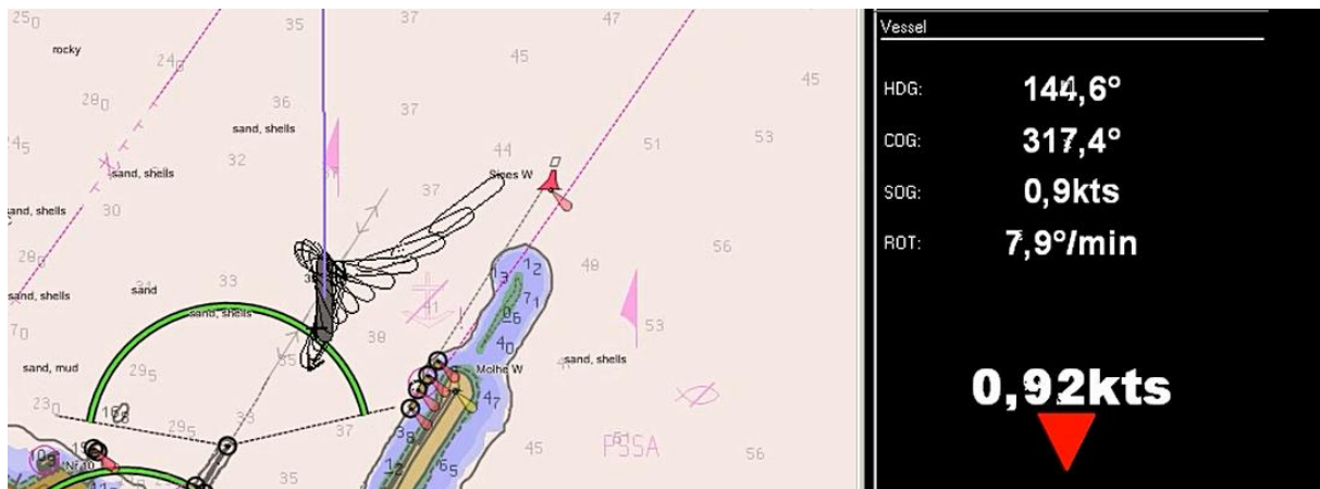
Figura 48 - Rotação com seguimento a ré do navio Astro Polaris com 274 metros de comprimento fora a fora, com vento entre oeste e sul com intensidade entre 15 e 20 nós
