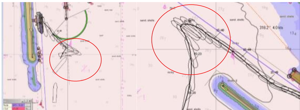
Figura 37 - Zona de rotação para navios de transporte de gás natural, graneis sólidos e líquidos
