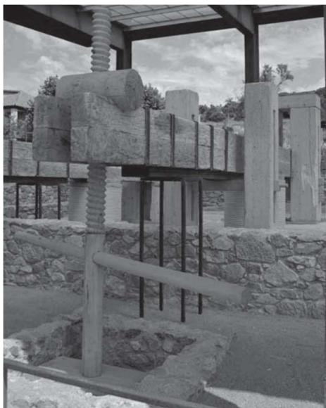
Figura 41. Recriação de prensa de alavanca e parafuso - Tipo 3
