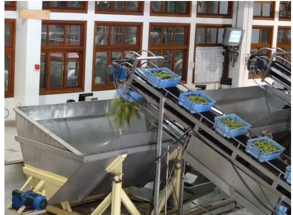
Figura 28. Descarga mecanizada das uvas para os tegões
