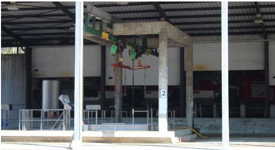
Mecanismo de transporte da uva do veículo para o desengace
