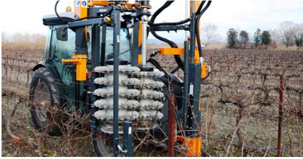
Figura 23. Trabalho de pré-poda mecânica
