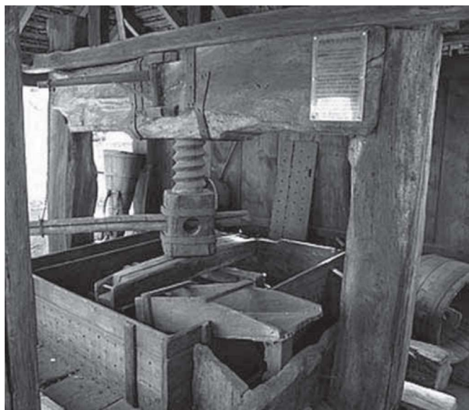
Figura 42. Recriação de prensa de parafuso direto - Tipo 4
