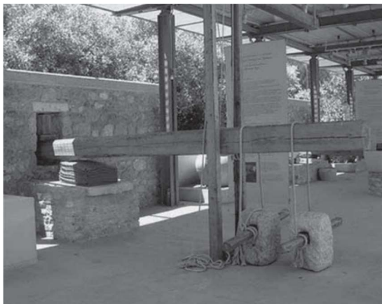
Figura 39. Recriação de prensa de alavanca e pesos – Tipo 1
