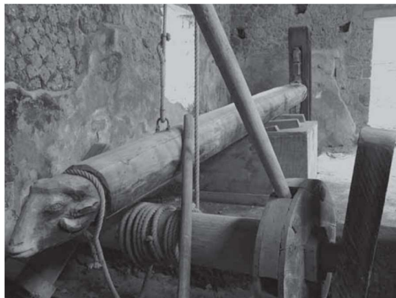
Figura 40. Recriação de prensa de alavanca e tambor - Tipo 2
