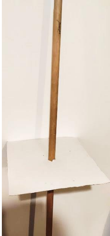
Figura 24. Representação do instrumento utilizado para a medição da altura do enrelvamento.
