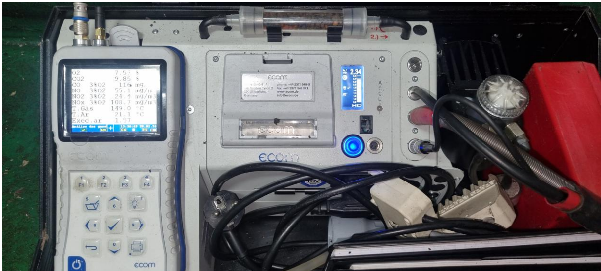
Figura 45- Aparelho de calibração do queimador da caldeira auxiliar.
