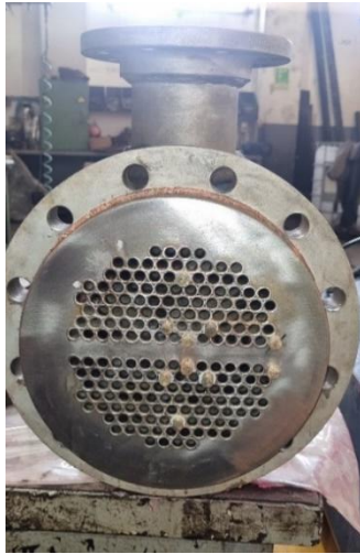
Figura 51- Isolamento de canais de refrigeração num refrigerador de óleo térmico.
