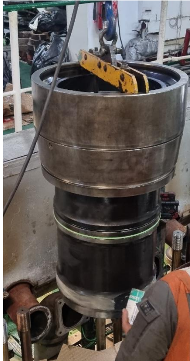
Figura 22- Preparação de uma camisa beneficiada para montagem na MPP.
