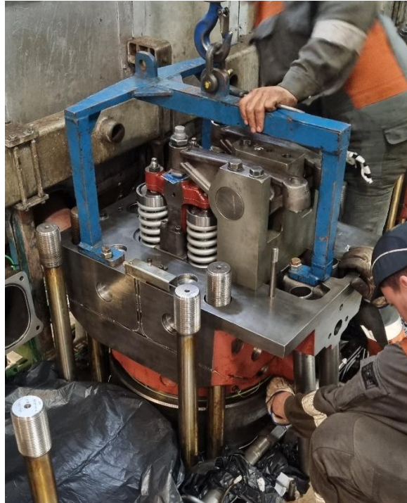
Figura 26- Fixação de uma cabeça da máquina principal.
