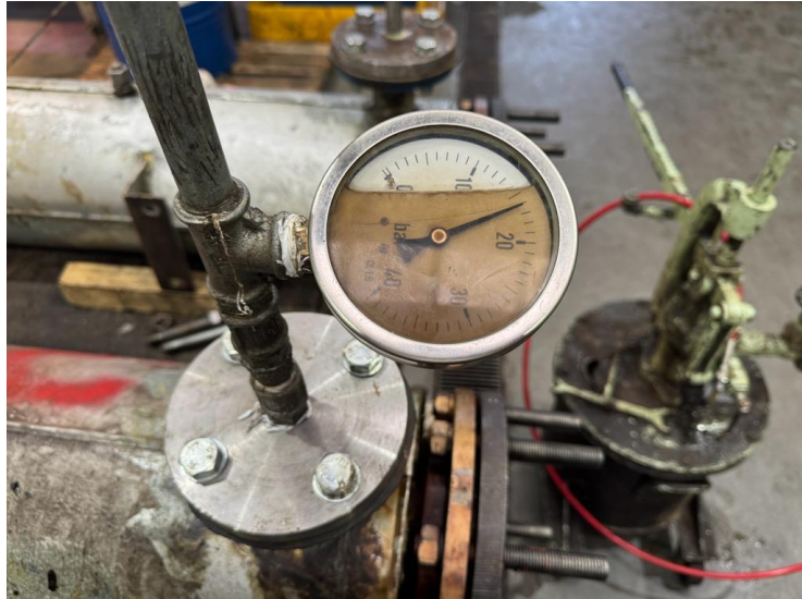
Figura 71- Teste de pressão a um aquecedor da unidade de combustível.
