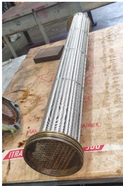
Figura 50- Miolo do refrigerador da caixa redutora.
