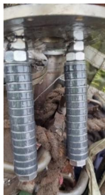
Figura 57- Retenção de partículas metálicas do sistema hidráulico das escotilhas.
