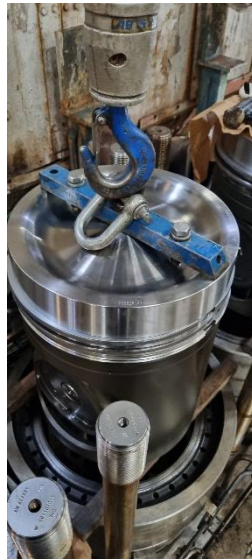
Figura 24- Colocação de um novo êmbolo na máquina principal.
