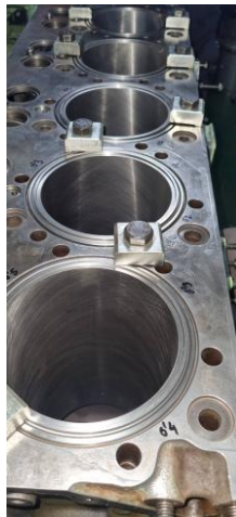
Figura 36- Camisas novas do gerador.
