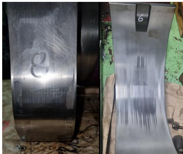
Figura 25- Capas com desgaste visível.
