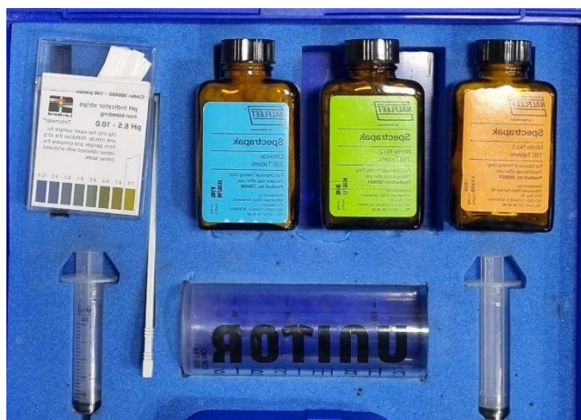
Figura 73- Kit de teste de água de refrigeração.
