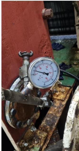
Figura 72- Teste de pressão a um refrigerador de BT.
