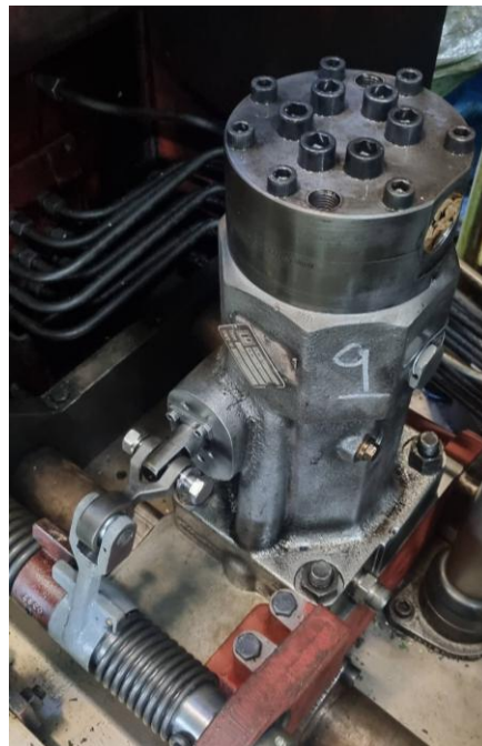
Figura 27- Bomba injetora da máquina principal.
