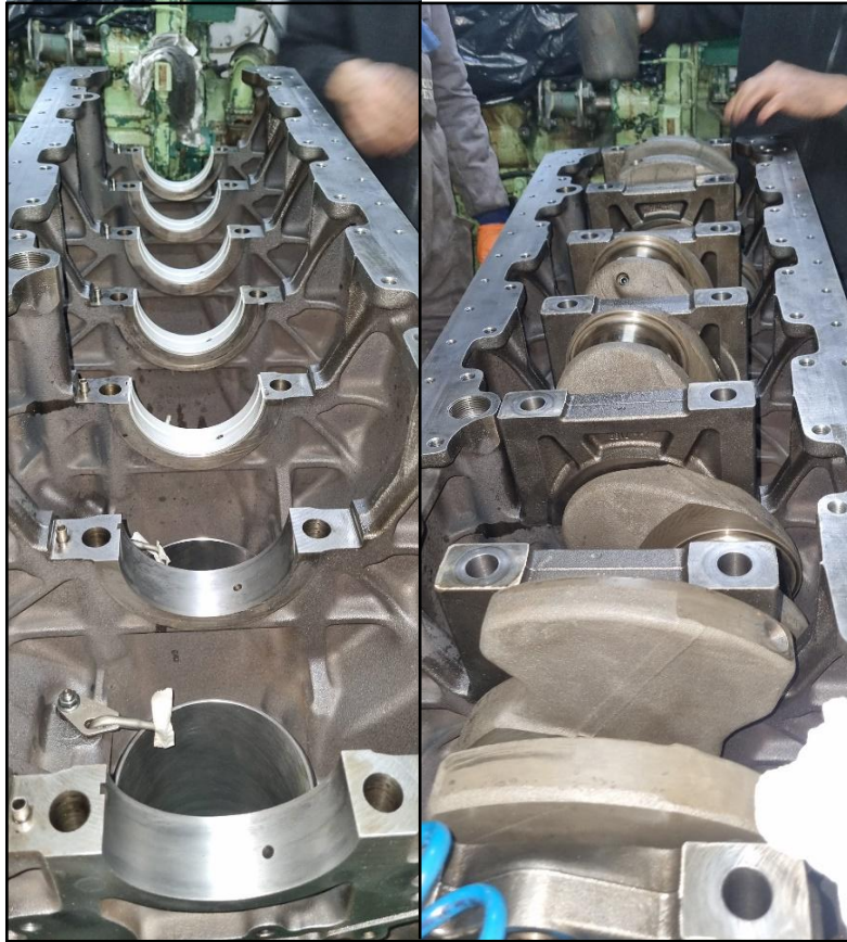
Figura 35- Colocação das capas e do veio de manivelas no bloco do gerador.
