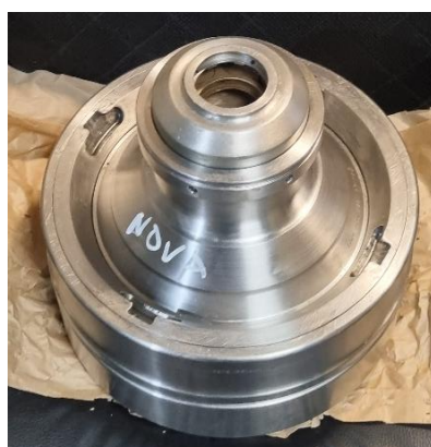
Figura 41- Recepção da taça da depuradora após equilibragem.
