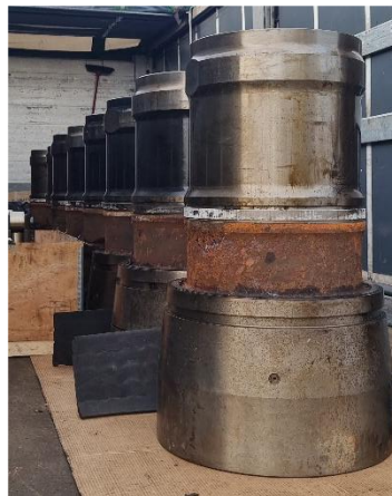
Figura 21- Camisas retiradas da MPP em transporte para a oficina.
