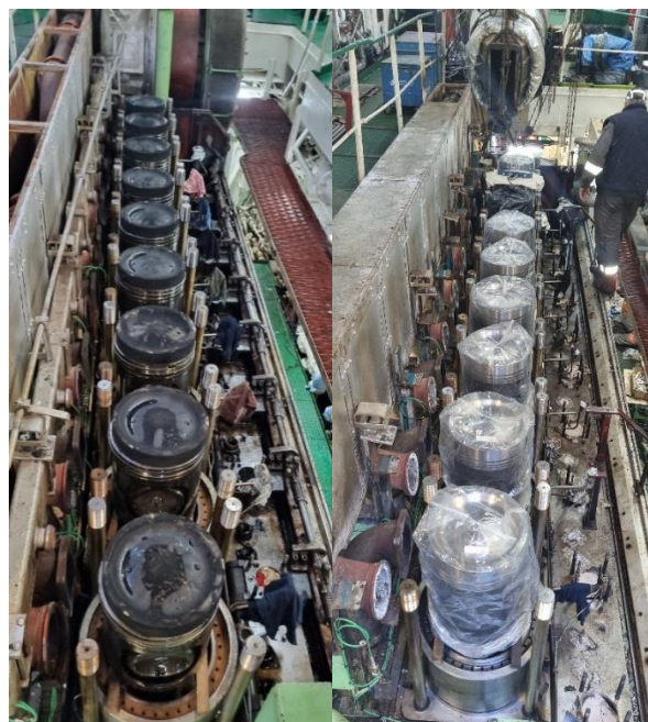
Figura 23- Substituição dos êmbolos da máquina principal por novos.
