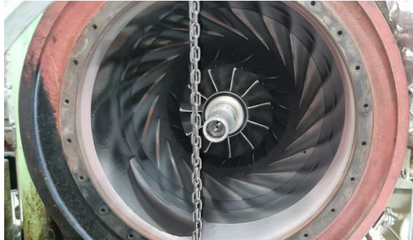
Figura 30- Desmontagem do turbocompressor.
