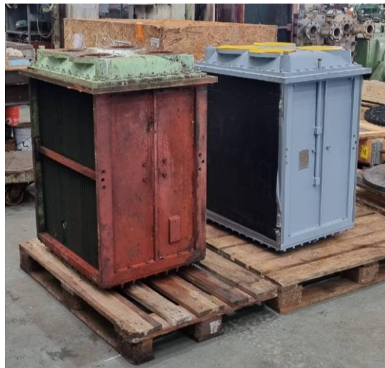
Figura 29- Refrigerador de ar usado e novo da MPP.
