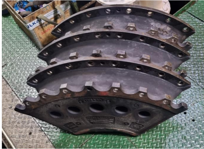
Figura 32- Quartelada da união elástica da máquina principal.
