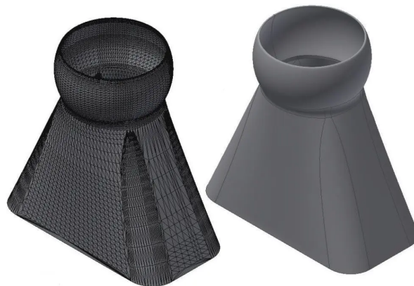
Figura 2.45: Modelo STL (esquerda) e modelo STEP (direita) - Fonte: (O’Connel, 2022)
