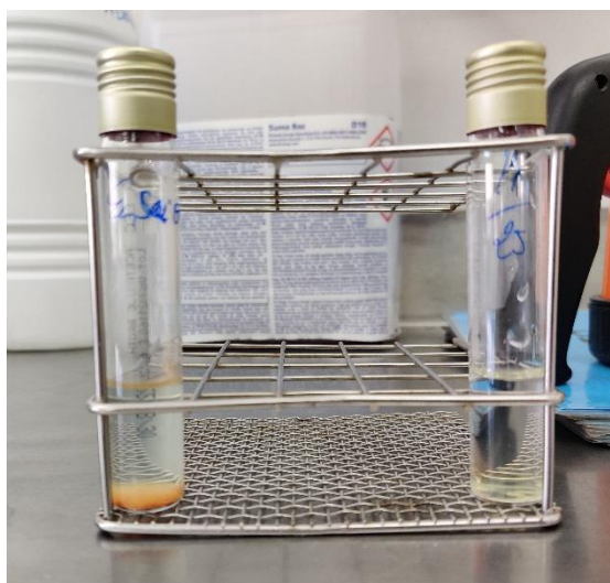
Figura 20 - Colónias testadas em Acetamide Broth depois da adição de 2 gotas de reagente Nessler. No tubo da esquerda houve produção de amónia, caracterizada pela produção de cor vermelho-tijolo, logo, considera-se a presença de Pseudomonas aeruginosa. No tubo da direita isso não aconteceu, logo, Pseudomonas aeruginosa não estará presente.
