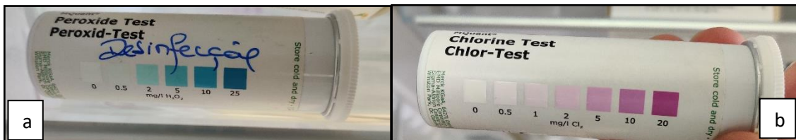
Figura 22 - Concentração de peróxido de hidrogénio (a) e de cloro (b) segundo a escala de cor fornecida pelo fabricante.
