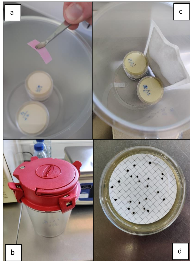
Figura 13 - a) Fita indicadora de anaerobiose cor-de-rosa; b) Jarra de anaerobiose fechada, contendo as placas invertidas, um gerador de anaerobiose e uma fita indicadora de anaerobiose. Marca-se na jarra, com um marcador, a data e hora de início da incubação; c) Abertura da jarra de anaerobiose depois de incubação na estufa a 37°C durante 48h. Pode observar-se que a fita mudou de cor-de-rosa para branco, garantindo as condições de anaerobiose; d) Colónias típicas de esporos de bactérias anaeróbias sulfito-redutoras, em 50mL de água duma amostra usada em ensaios interlaboratoriais.
