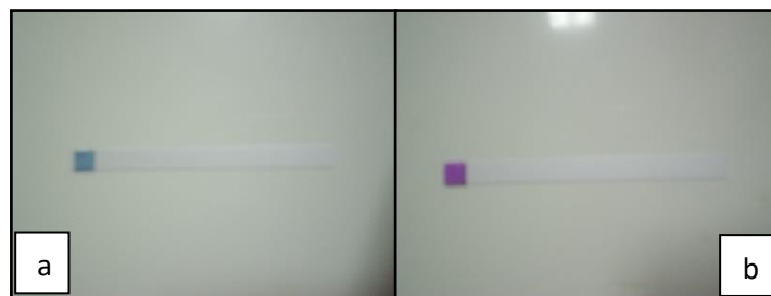
Figura 23 - Teste positivo com a coloração que as tiras devem apresentar após desinfecção. Concentração 25mg/L para o peróxido de hidrogénio (a) e 20mg/L para o cloro (b). A concentração pretendida é a máxima da escala pois as concentrações utilizadas no sistema CIP serão sempre superiores a essas.
