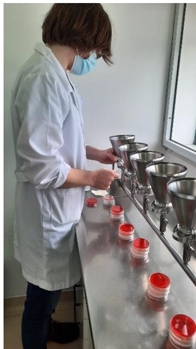
Figura 12 - Técnica de filtração por membrana usando a rampa de filtração.
