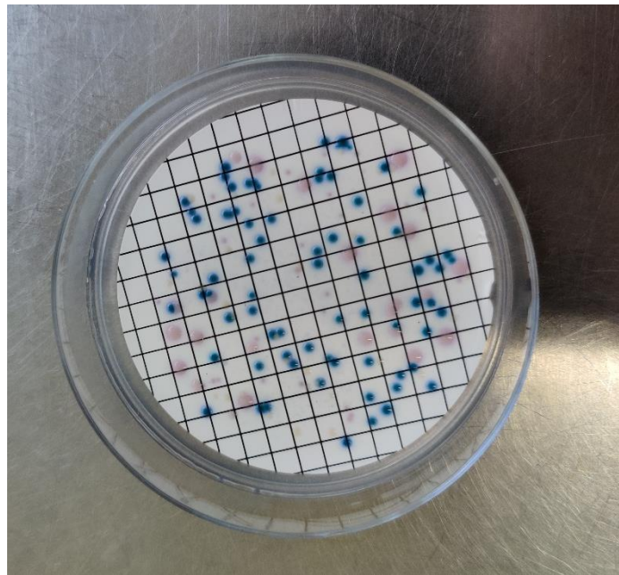
Figura 14 - Colónias típicas de E. coli (azuis) e de bactérias coliformes que não são E. coli (rosa), em 250mL de água numa amostra usada em ensaios interlaboratoriais.
