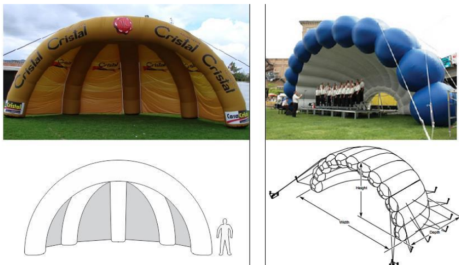
Figura 25 / 26 - Duas situações de conchas acústicas móveis (ambas insufláveis e destinadas ao uso no exterior).
