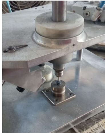
Figura 5.19 - Matriz pronta a cortar calibrada para o tipo de matriz
