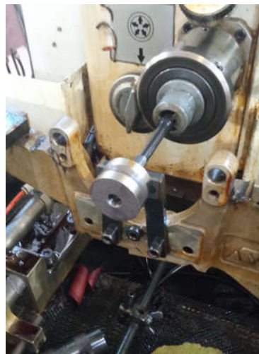
Figura 4.7 - Aperto da matriz e ferramenta posicionada
