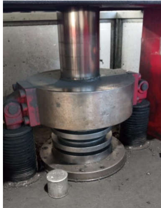
Figura 5.22 – Processo de extrusão das matrizes
