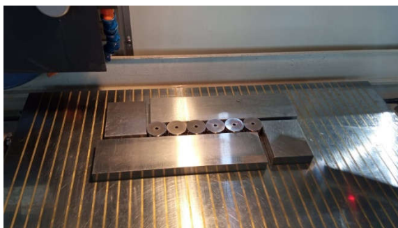
Figura 3.39 – Montagem das matrizes na mesa magnética da máquina.
