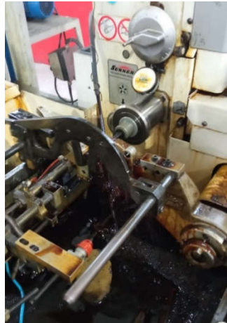
Figura 3.26 – Processo de retificação diâmetro interior – Oning
