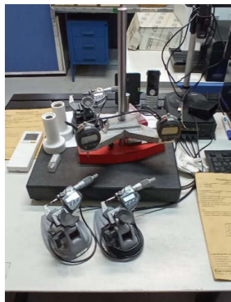
Figura 3.47 – Instrumentos de medida do controle qualidade das matrizes
