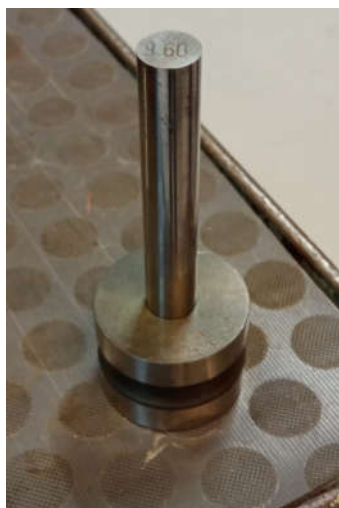
Figura 5.12 – Calibre passa não passa da matriz
