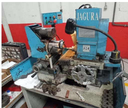
Figura 3.28 – Processo de retificar matrizes
