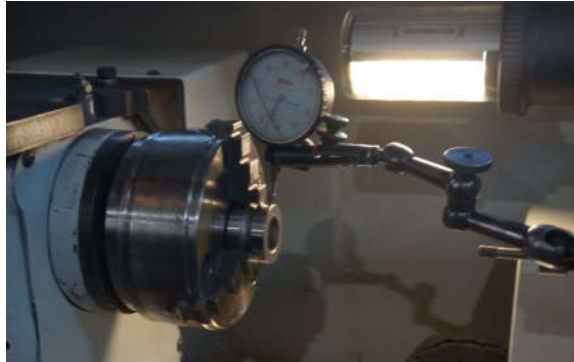
Figura 3.18 – Montagem e calibração da matriz
