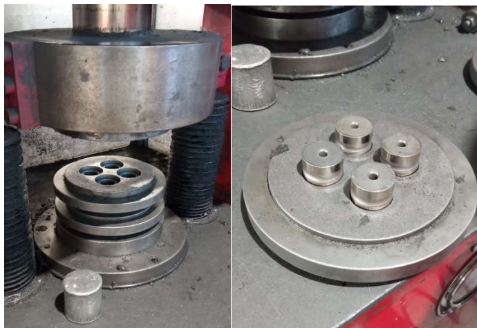
Figura 5.21 – Montagem da base e das matrizes na base
