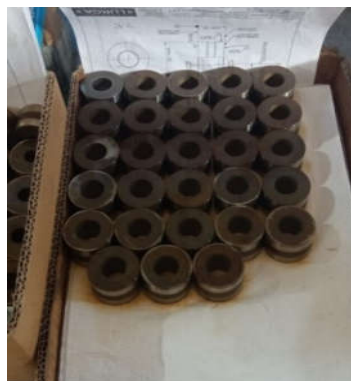
Figura 5.18 - Matrizes oleadas para evitar processo de corrosão
