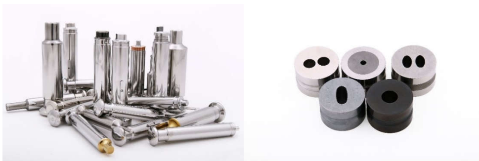
Figura 3.2 - Ferramentas de compressão, esquerda punções e direita matrizes [22]
