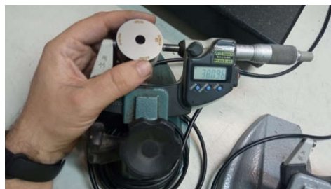
Figura 3.48 – Controlo dimensional dos diâmetros exteriores da matriz com micrómetro digital.
