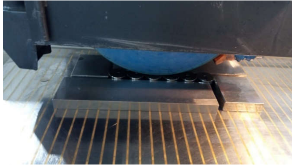
Figura 3.40 – Alinhamento da mó com as matrizes
