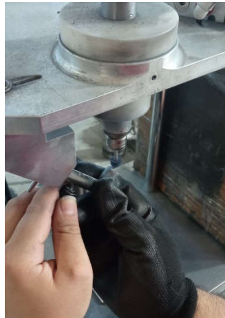
Figura 5.17 - Retificação da mó a 45^\circ
