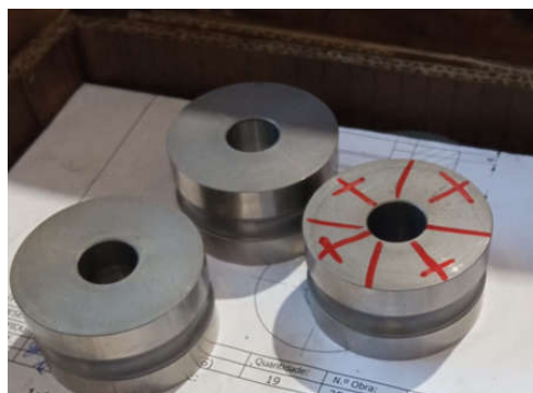
Figura 4.5 - Matriz tipo D rejeitada
