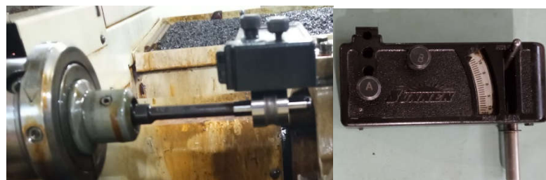
Figura 3.25 – Calibração e centrado da matriz no mandril
