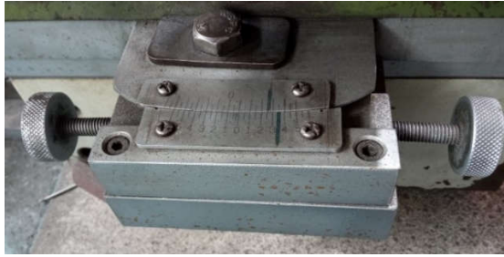
Figura 3.31 – Calibração do ângulo de inclinação no lado da bucha
