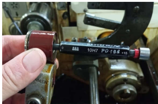
Figura 3.27 – Controle dimensional com calibre passa não passa
