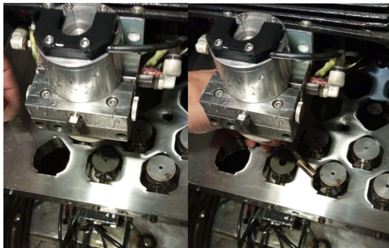
Figura 5.9 – Retirada do desperdício com ímã da mesa da máquina
