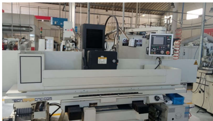
Figura 3.37 – Tecnologia de retificação para alturas finais
