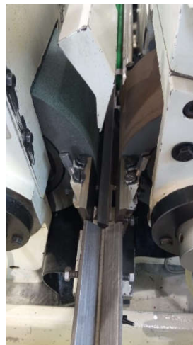
Figura 4.3 - Régua da máquina Centerless retificar diâmetros exteriores
