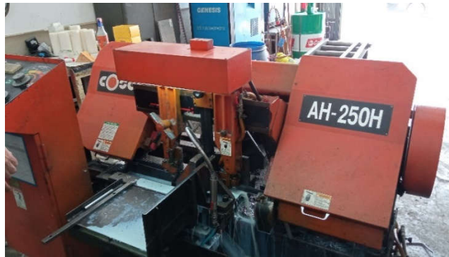
Figura 3.2 – Serrote para corte da matéria-prima
