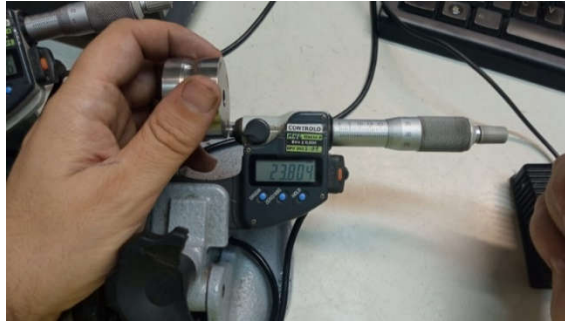
Figura 3.49 – Controlo dimensional das alturas finais da matriz com micrómetro digital.
