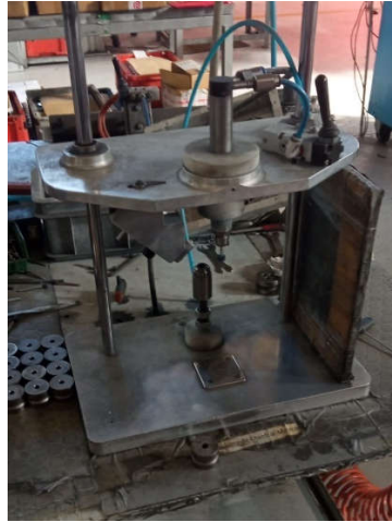
Figura 5.16 - Máquina de chanfrar saídas das matrizes
