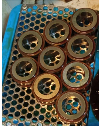
Figura 5.13 – Oxição das matrizes após processo de eletroerosão de fio
