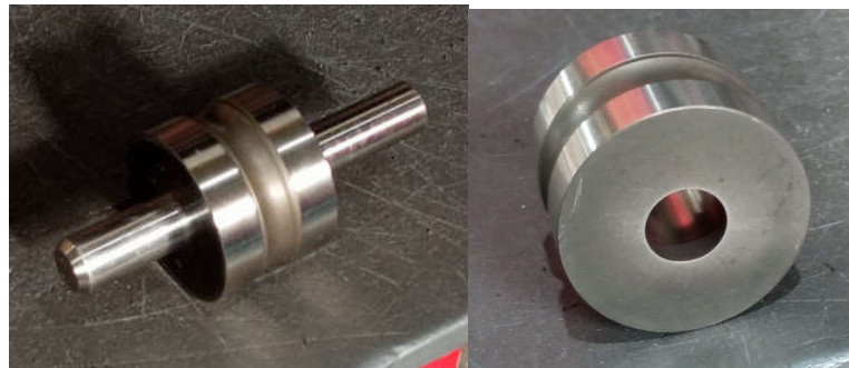
Figura 5.14 – Calibre passa não passa e acabamento da matriz após escoamento abrasivo
