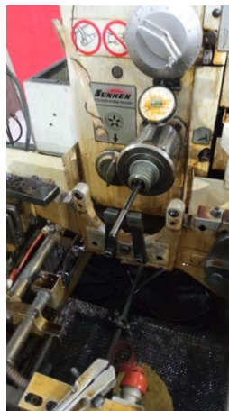
Figura 3.24 – Colocação do mandril na máquina de honing
