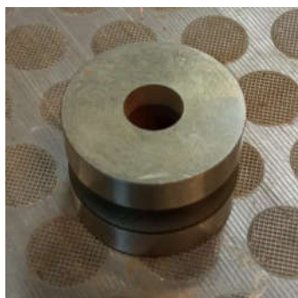
Figura 5.10 – Matriz de ensaio depois de acabada
