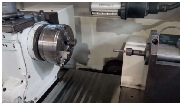
Figura 4.4 - Aperto e ferramenta da Centrar furos PAM
