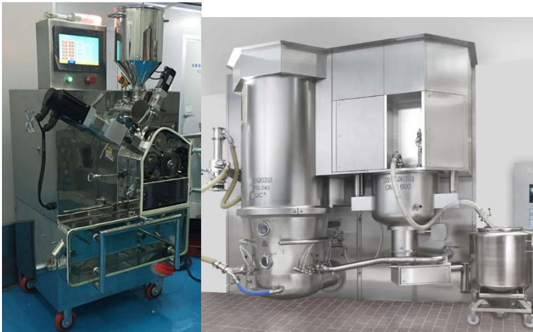
Figura 7.3 - Máquina granulação a seco (esquerda) [7] e máquina granulação via húmida (direita) [8]
