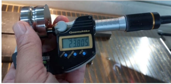
Figura 3.43 – Medição final das matrizes
