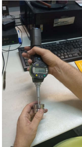
Figura 3.50 – Controlo dimensional do furo da matriz com micrómetro de interiores.
