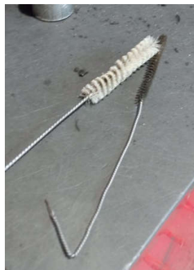
Figura 5.24 – Escovilhão para limpeza do furo da matriz após extrusão
