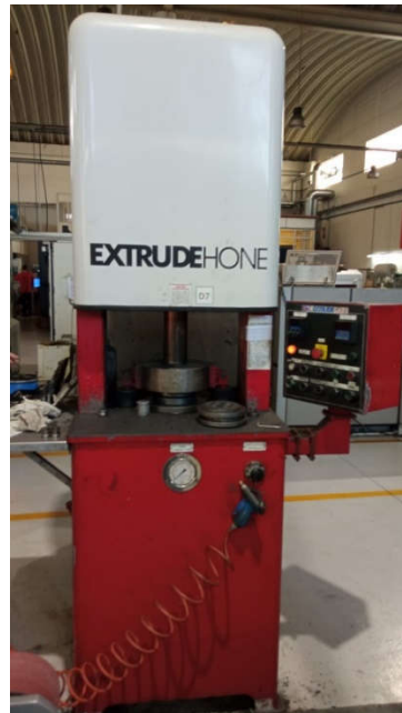
Figura 5.20 - Processo de Extrusão - Extrudehone
