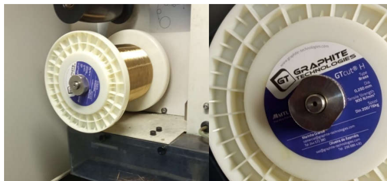
Figura 5.4 - Bobina de fio do processo de eletroerosão de fio
