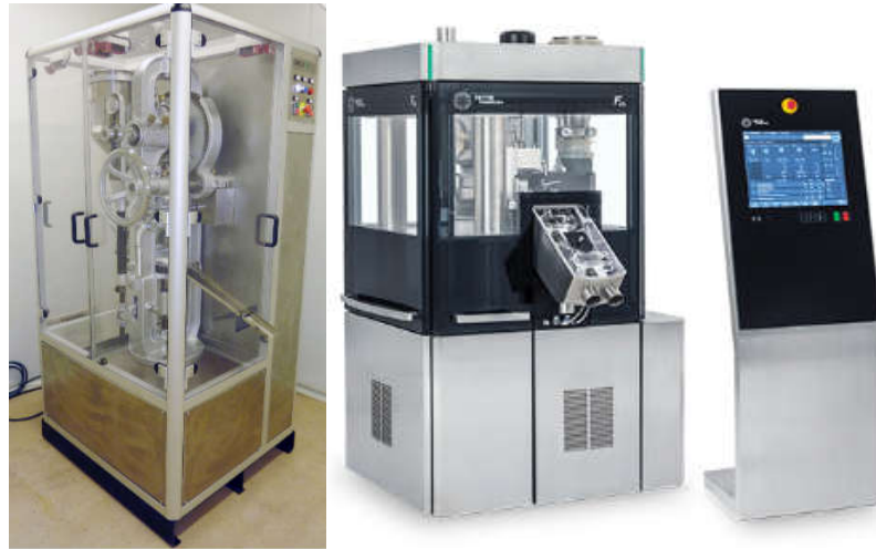
Figura 2.2– máquina de compressão excêntrica à esquerda [11] e máquina de compressão rotativa à direita [12]
