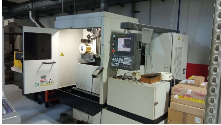
Figura 5.3 – Processo de eletroerosão de fio
