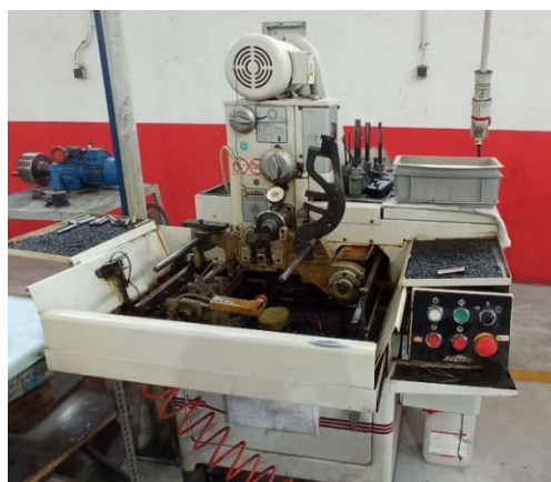
Figura 3.22 – Processo de retificação de diâmetros interiores das matrizes para cota final – honing
