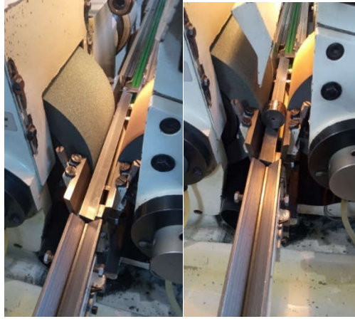
Figura 3.13 – Calibração da máquina e das matrizes na Centerless
