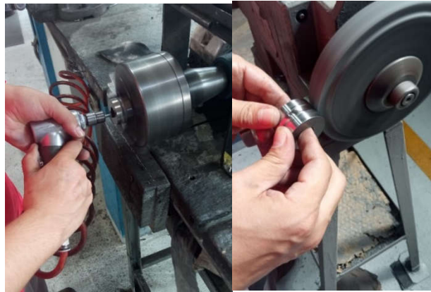
Figura 3.35 – Polimento do furo (esquerda) e polimento exteriores (direita).
