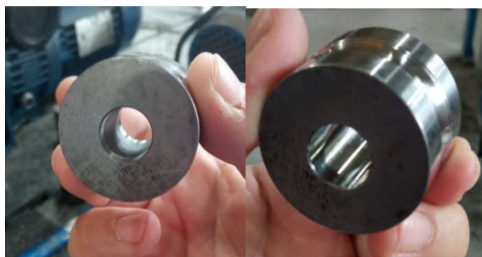
Figura 3.36 – Antes de polimento e depois de polimento
