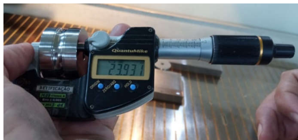
Figura 3.42 – Medição das matrizes da primeira fase
