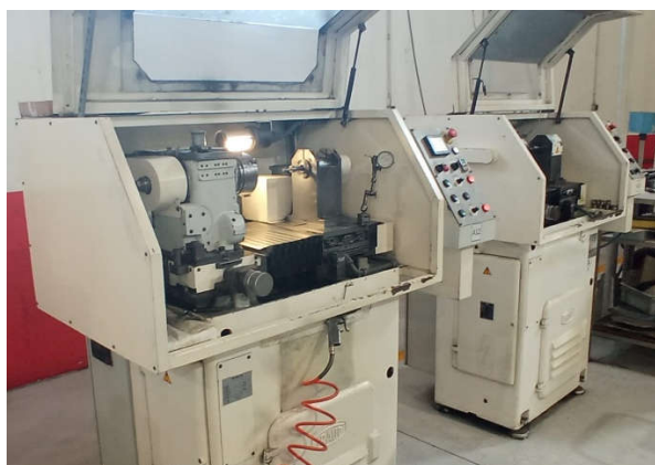
Figura 3.17 - Processo de retificação de diâmetros interiores das matrizes
