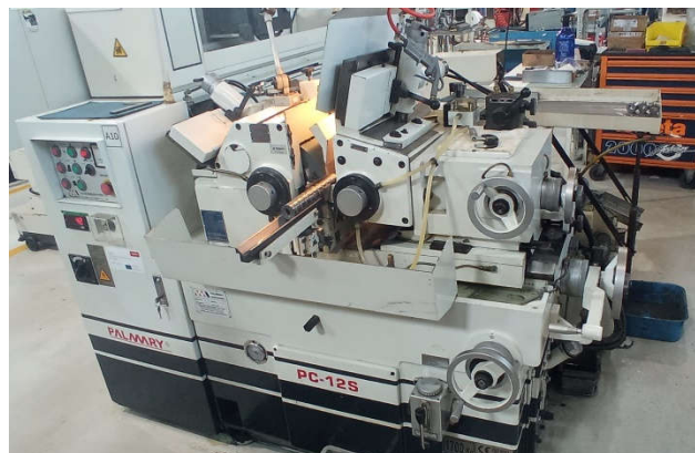
Figura 3.12 – Processo de retificação de diâmetros exteriores das matrizes
