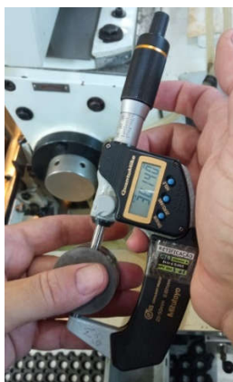
Figura 3.15 – Controle do diâmetro exterior com micrômetro
