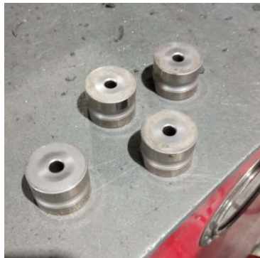
Figura 5.23 – Matrizes após processo de extrusão
