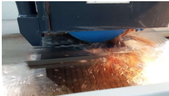
Figura 3.41 – Corte das matrizes na máquina
