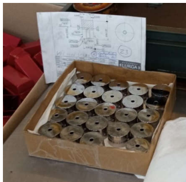
Figura 3.52 – Matrizes lubrificadas com óleo
